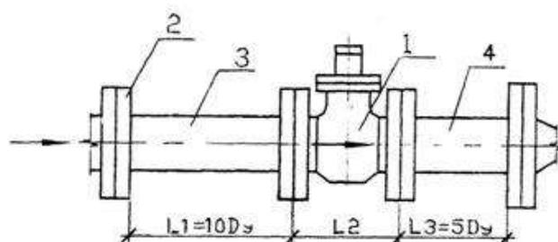
Рисунок 4 Схема монтажа: 1 - счетчик воды; 2 - фланец по ГОСТ 12815; 3 - патрубков; 4 – патрубков.
