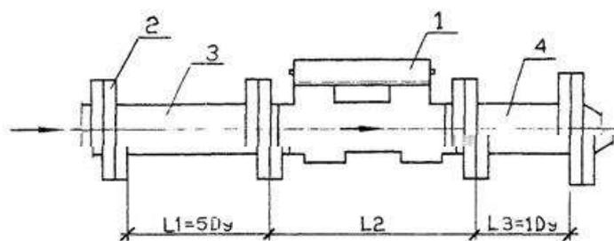
Рисунок 6 Схема монтажа: 1 - ультразвуковой счетчик; 2 - фланец; 3, 4 – патрубок.
