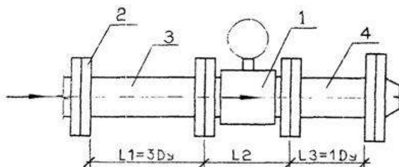
Рисунок 8 Схема монтажа: 1 - электромагнитный счетчик; 2 - фланец; 3, 4 – патрубок
