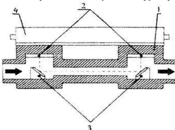
Рисунок 5 Конструкция счетчика ультразвукового типа:
