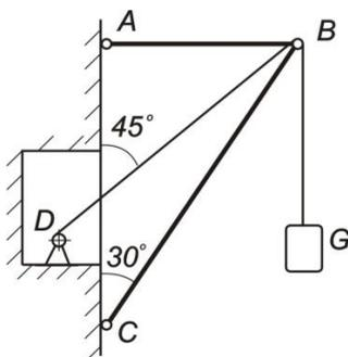
Груз веса  $G = 400$  Н равномерно поднимается посредством троса, перекинутого через блок  $B$ . Другой конец троса намотан на барабан лебедки  $D$ . Определить усилия в стержнях  $AB$  и  $BC$  пренебрегая весом стержня. Крепления стержней в точках  $A$ ,  $B$  и  $C$  – шарнирные.
