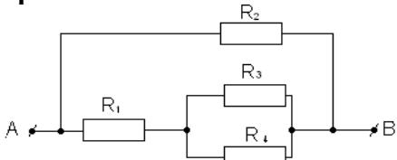
Дано:  $R_1=2 \text{ Ом}$  $R_2=4 \text{ Ом}$  $R_3=3 \text{ Ом}$  $R_4=6 \text{ Ом}$ Общее напряжение  $U_{AB}=120\text{В}$ Найти: Сопротивление всей цепи; Силу тока до разветвления и в каждом резисторе; Мощность на сопротивление  $R_1$ .**Тема 3.4. Магнитное поле****П.3.12*****Примерные варианты заданий:*****Вариант 1**
