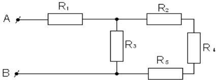
Дано:  $R_1=1 \text{ Ом}$  $R_2=1 \text{ Ом}$  $R_3=10 \text{ Ом}$  $R_4=8 \text{ Ом}$  $R_5=1 \text{ Ом}$ Сила тока в первом резисторе  $10A$
