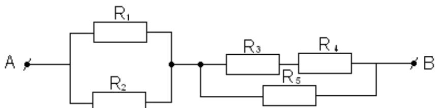
Дано:  $R_1=12 \text{ Ом}$      $R_2=4 \text{ Ом}$      $R_3=5 \text{ Ом}$      $R_4=7 \text{ Ом}$      $R_5=13 \text{ Ом}$
