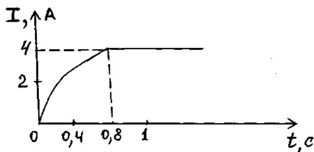
3. На рисунке дан график возрастания силы тока в катушке индуктивностью  $8 \text{ Гн}$  при замыкании цепи. Определить ЭДС индукции, возникающей в катушке.
