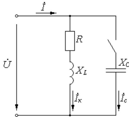
Рисунок 1 – Линейная электрическая цепь переменного тока
