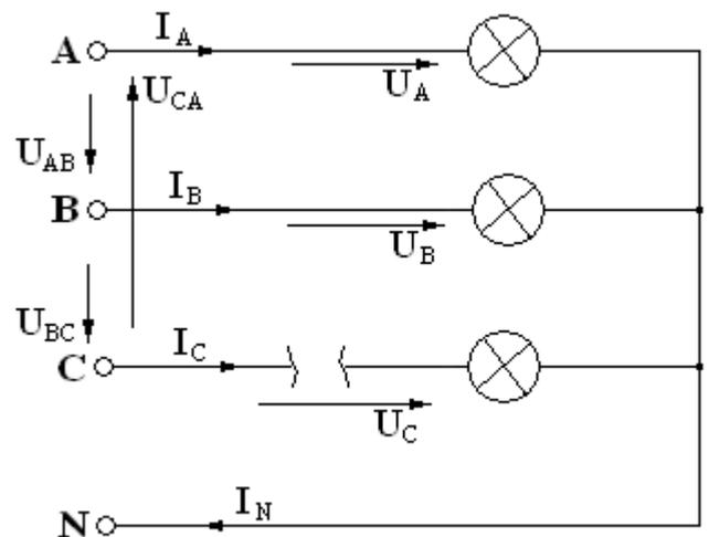
Рисунок 3 – Трехфазная электрическая цепь, соединение нагрузки по схеме «звезда»
