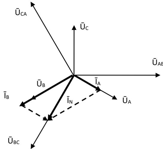
Рисунок 4 – Векторная диаграмма токов и напряжений
