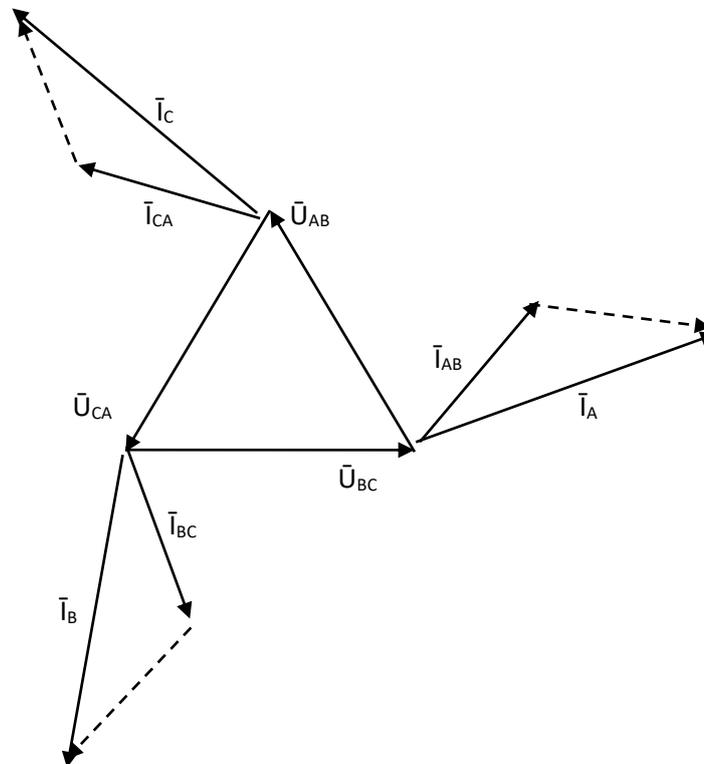
Рисунок 6 – Векторная диаграмма токов и напряжений
