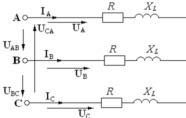
Рисунок 7 – Схема включения нагрузки по схеме «звезда»
