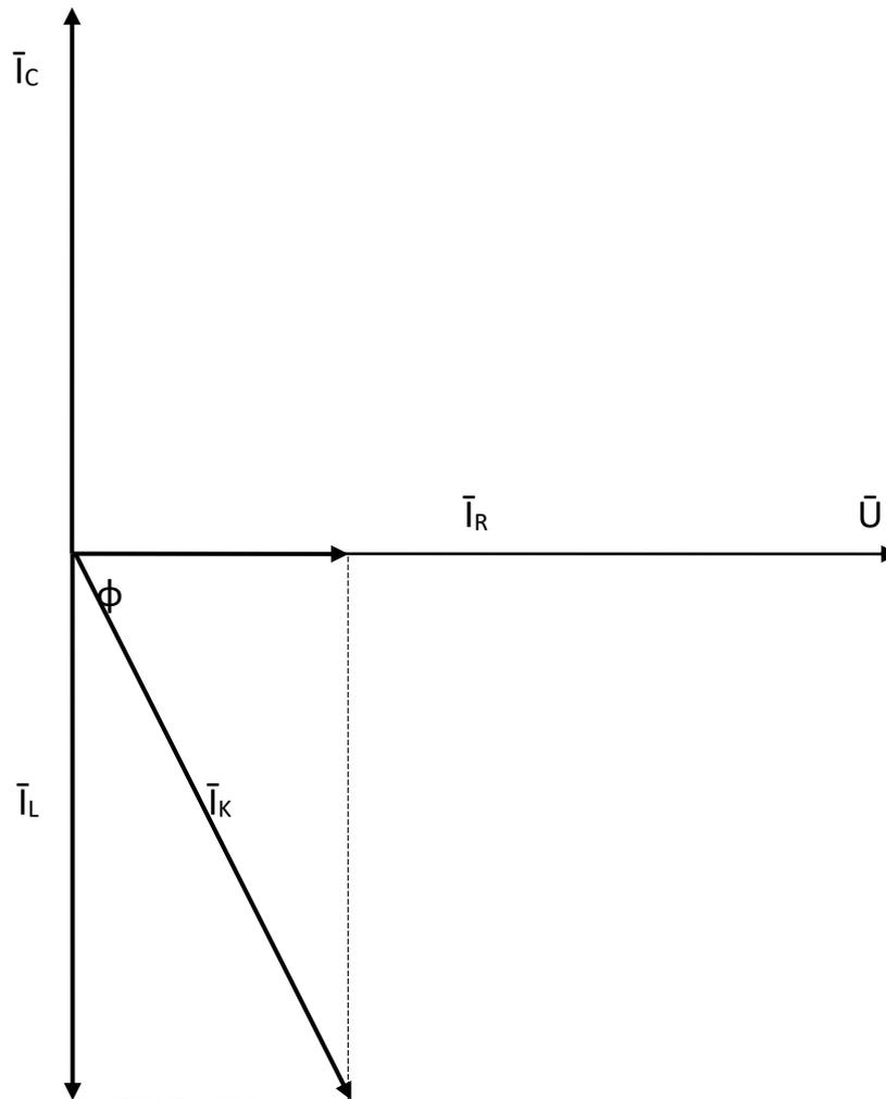
Рисунок 2 – Векторная диаграмма токов и напряжения
