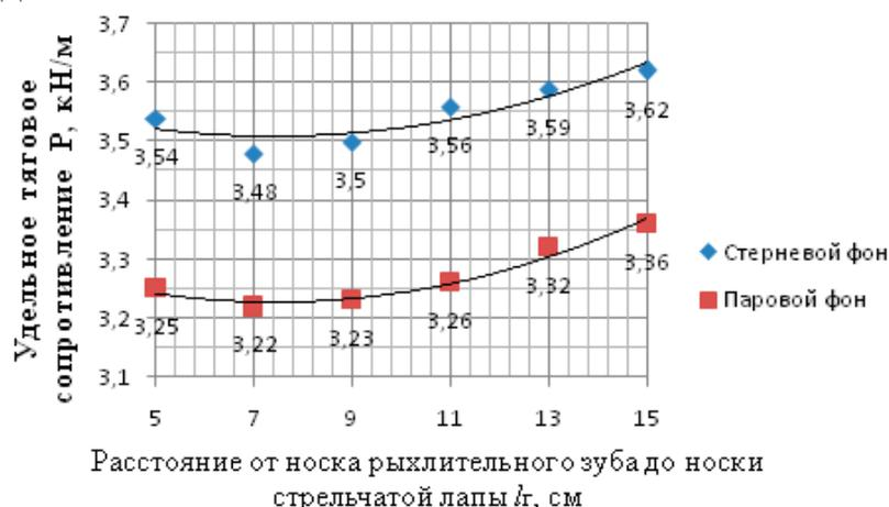
Рис. 6.4. Влияние расстояния от носка рыхлительного зуба до носка стрельчатой лапы на удельное тяговое сопротивление
