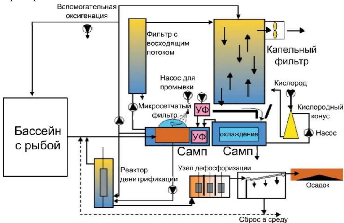
**Рисунок 1- Схема УЗВ**
