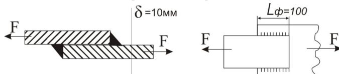
76. Напишите уравнение прочности для сварного соединения, изображенного на рисунке:
