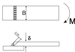
99. В соединении уголка №10 с косынкой по условиям прочности требуются швы общей длиной  $L_1+L_2=200\text{mm}$ . Определите  $L_1$  и  $L_2$ , если  $a=27\text{mm}$ .
