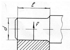
142. Проверьте на прочность листы заклепочного соединения /см. рис./ по сечению 1-1, если  $F=24$  кН, допускаемое напряжение на разрыв для материала листов  $[\sigma_p]=140$  МПа.
