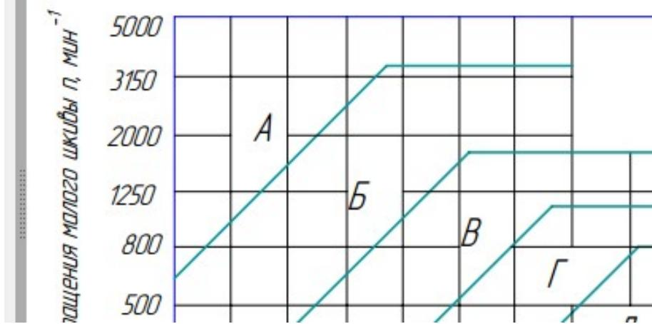
Рис. 2 Номограмма определения требуемого сечения ремня
