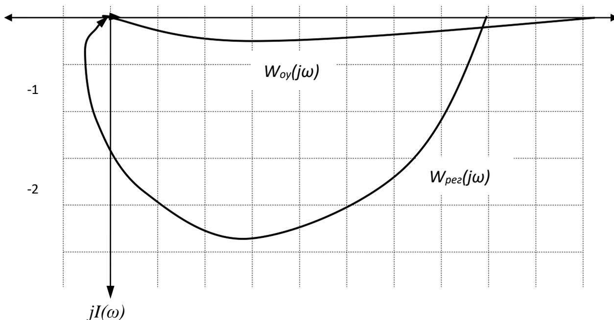
Рисунок 4 – Построение АФЧХ объекта управления и регулятора
