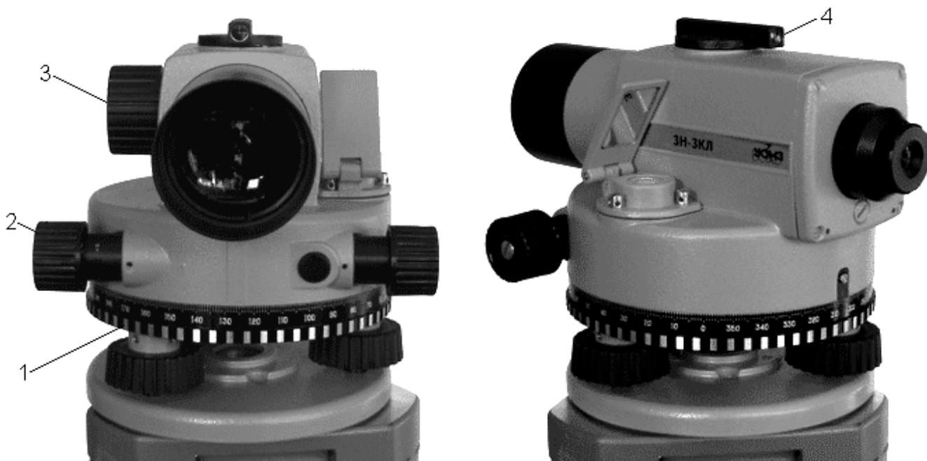
Рисунок 3. Точный нивелир ЗН-ЗКЛ с компенсатором и лимбом: 1 – лимб; 2 – наводящий винт; 3 – кремальера; 4 – визир
