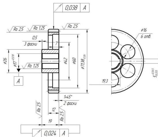
Рис 2.3 – Деталь типа «Колесо зубчатое»
