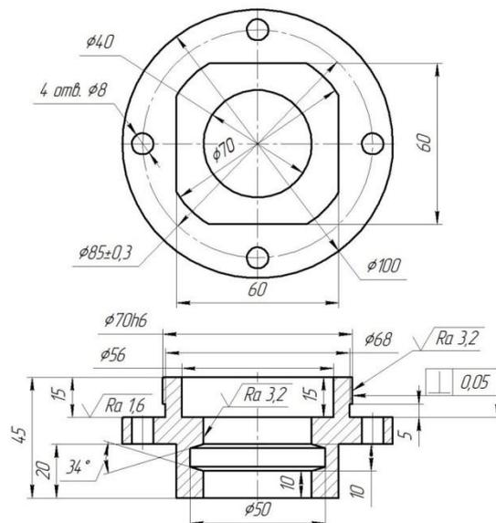
Рис. 2.5 – Деталь типа «Крышка»
