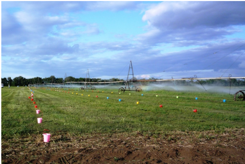
Рис. 14. Расстановка дождемеров вдоль водопроводящего трубопровода ДМ «Фрегат».
