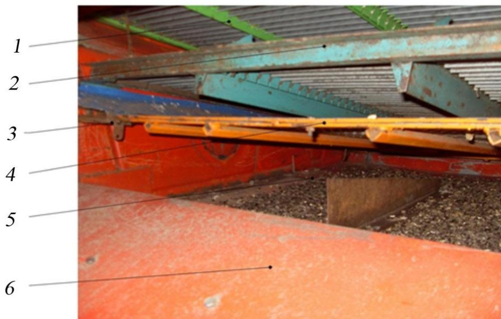
Рисунок 5.1 – Установка решета с регулируемыми отверстиями:
