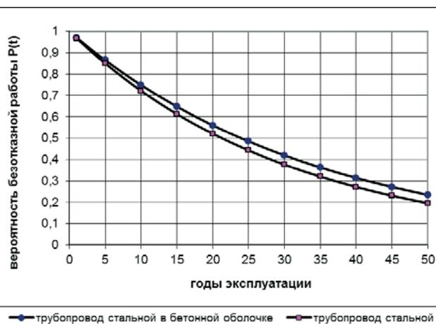
График изменения вероятности безотказной работы трубопроводов по годам эксплуатации
