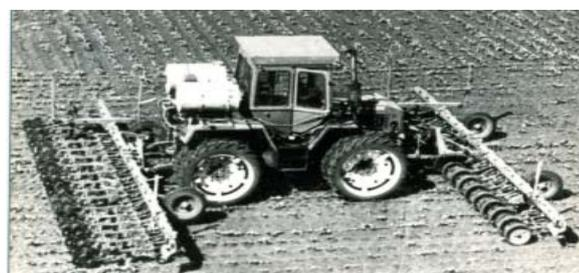
Рис. 3. Трактор ЛТЗ-145 в агрегате с подкормщиком-опрыскивателем ПОМ-1200 и навесными 18-рядными прореживателем и культиватором за обработкой посевов сахарной свеклы на поворотной полосе
