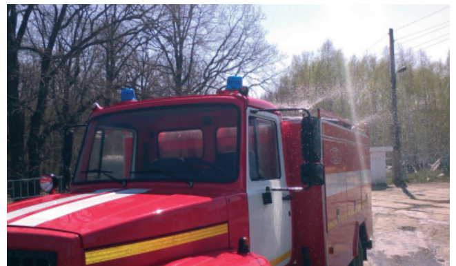
Рис. 1. Пожарная машина, оборудованная водяной завесой
