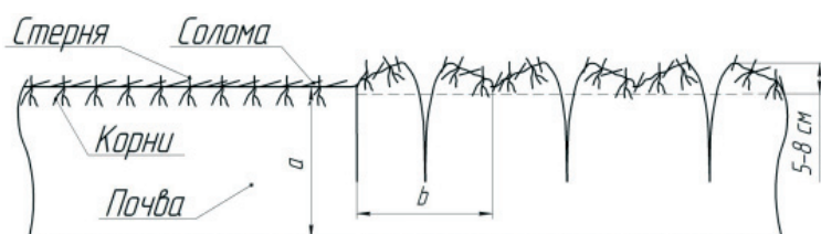
Рис. 4. Схема обработки пласта почвы безотвальными орудиями
