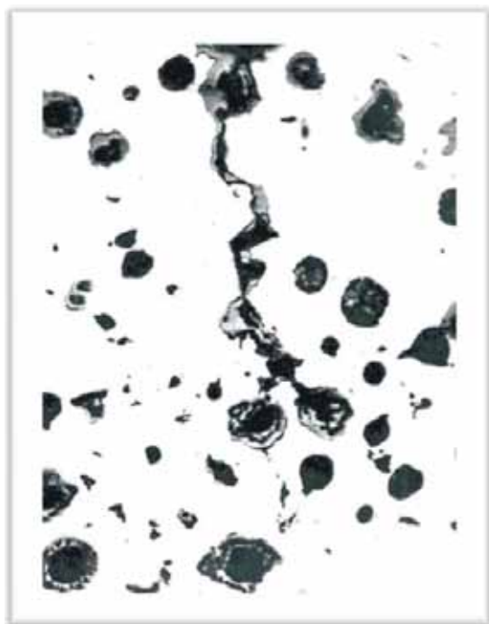
Рис. 2. Структура чугуна с содержанием иттрия 0,15–0,20 %
