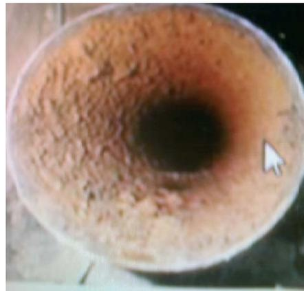
Рис. 1. Обрастание стального напорного трубопровода  $d = 300$  мм
