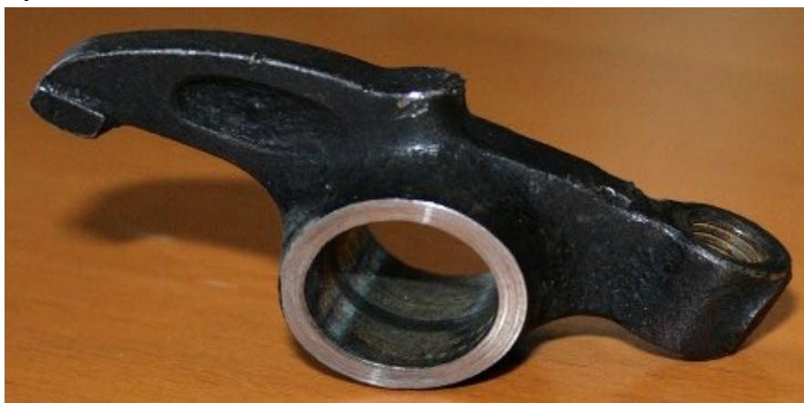
Рисунок 12. Коромысло легковых и грузовых автомобилей ГАЗ-2410, ГАЗ-66 и ГАЗ-53
