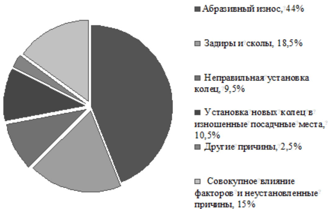
Рисунок: 1 –: Основные причины: отказов двигателей: вследствие нарушения: функционирования деталей: цилиндропоршневой группы
