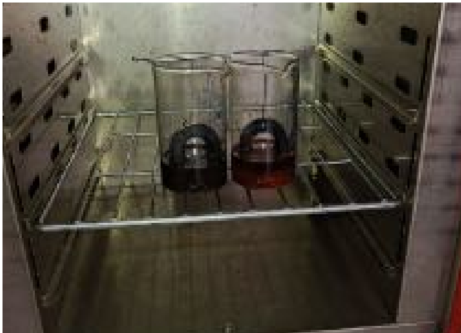
Рисунок 2. Испытание на набухание уплотнительных устройств
