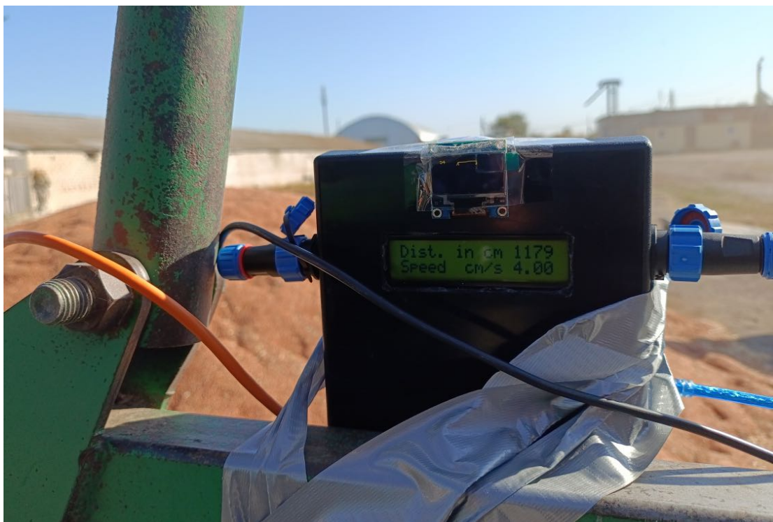
Рисунок 2. Значения расстояния до бурта, и скорости приближения к массиву груза на ЖК экране разработанного устройства авизированного контроля режимных параметров
