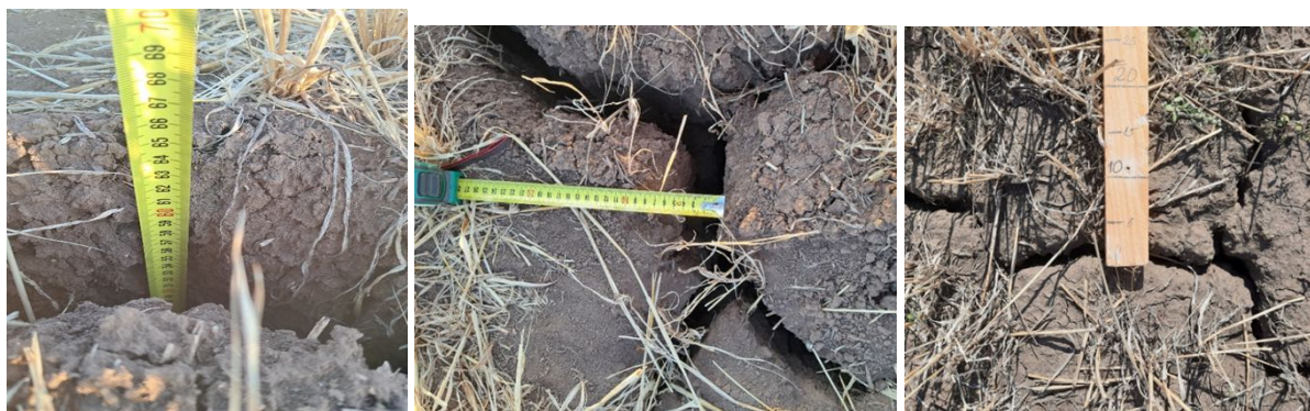
Рисунок 5. Замер глубины и ширины трещин
