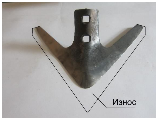
Рисунок 1. Изношенные рабочие органы: а - сеялки-культиватора Bouragult 8810; б - культиватор КПС-4Г; в - культиватор Lemken Kompaktor; г - культиватора КШУ-12Н
