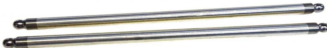
Рисунок 11. Штанги клапанов двигателя ЗМЗ-402 для автомобилей «Волга», «ГАЗель», микроавтобусы «Латвия» и УАЗ
