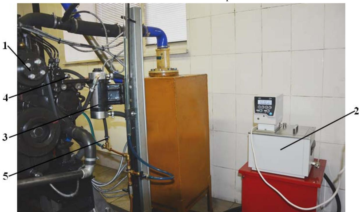
Рисунок 1. Система поддержания постоянной температуры топлива на входе в ТНВД: 1 – дизель MMZ-3LD; 2 – жидкостный термостат ВТ8-2; 3 – жидкостный подогреватель дизельного топлива ПТ 570; 4 – термопреобразователь сопротивления ТС-1388В; 5 – линия подачи топлива к ТНВД
