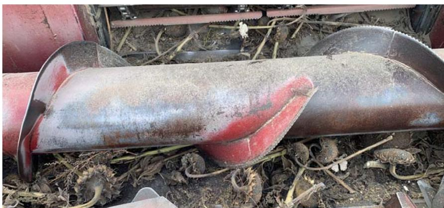
Рисунок 2. Центральная зубчатая часть шнека адаптера НАШ-873
