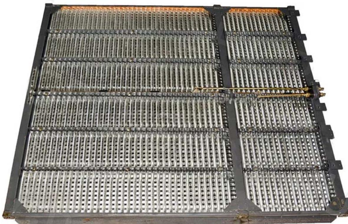
Рисунок 5. Верхнее решето с удлинителем комбайнов КЗС-10 и КЗС-1218
