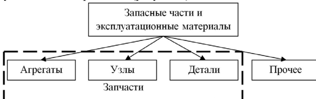
Рисунок 2. Пример распределения запчастей и эксплуатационных материалов
