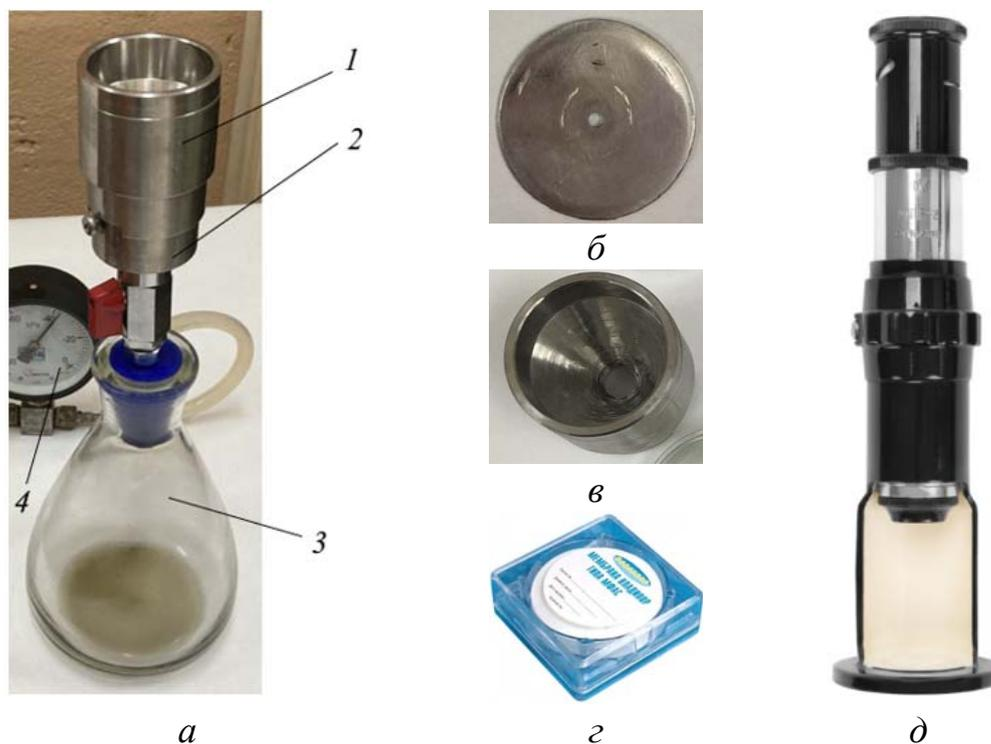
Рисунок 1. Установка для патч-тестирования: *а* – внешний вид (*1* – воронка; *2* – фильтродержатель; *3* – колба; *4* – вакуумметр, подключенный к вакуумному насосу); *б* – концентрирующая прокладка с центральным отверстием диаметром 3 мм; *в* – воронка с отверстием диаметром 10 мм; *г* – набор мембранных фильтров; *д* – микроскоп МПБ-2
