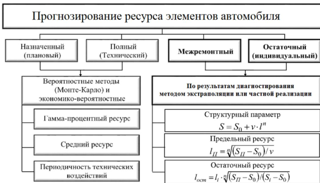
Рисунок 1. Виды и методы прогнозирования ресурса агрегатов АТС
