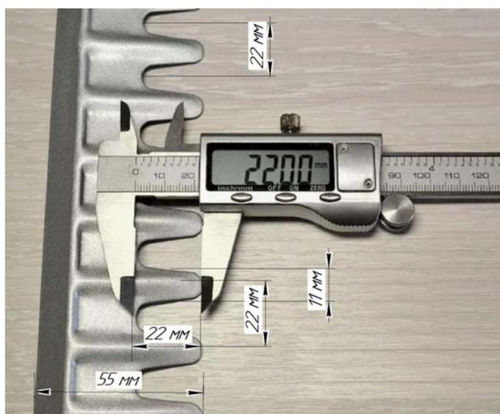
Рисунок 3. Фрагмент гребёнки верхнего решета системы очистки комбайна Case IH 8010 Axial Flow
