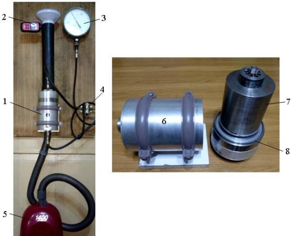
Рисунок 1. Испытательный стенд и общий вид опытной газовой центрифуги с вихревым приводом: 1 – центрифуга; 2 – анемометр; 3 – вакуумметр; 4 – распределительный кран; 5 – пылесос; 6 – корпус центрифуги; 7 – ротор; 8 – основание корпуса с направляющим аппаратом привода
