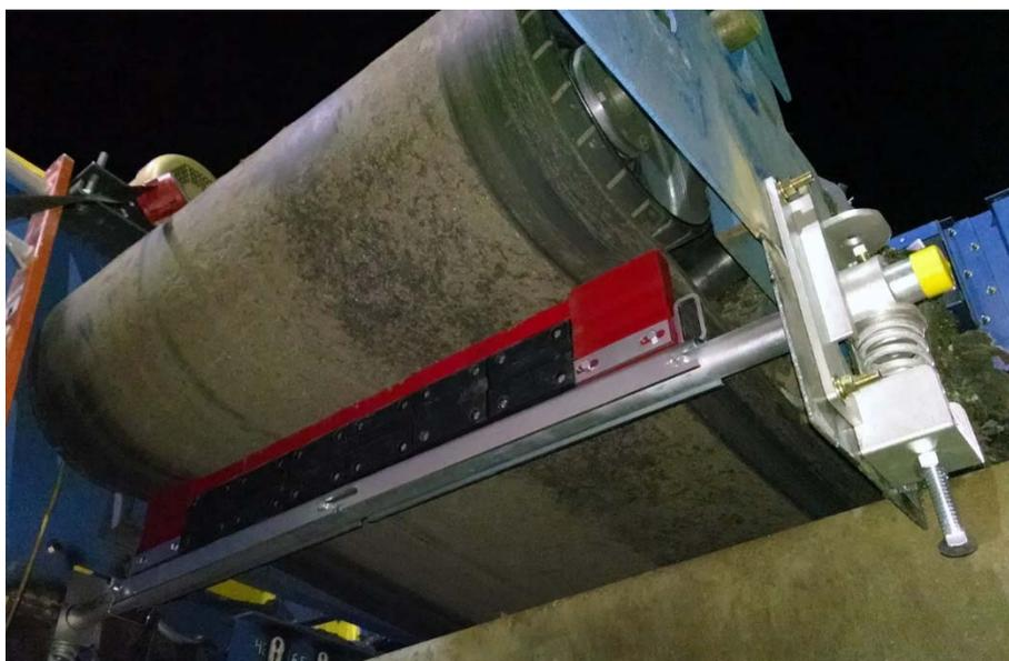
Рисунок 2. Скребок тонкой очистки
