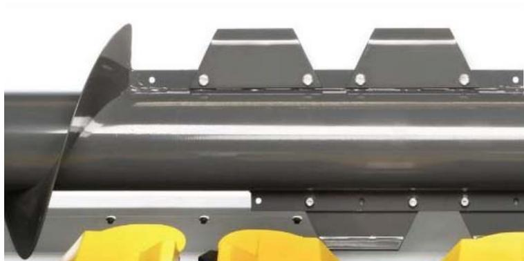
Рисунок 5. Съёмные регулируемые лопасти шнека адаптера «Fantini» G03-GH3
