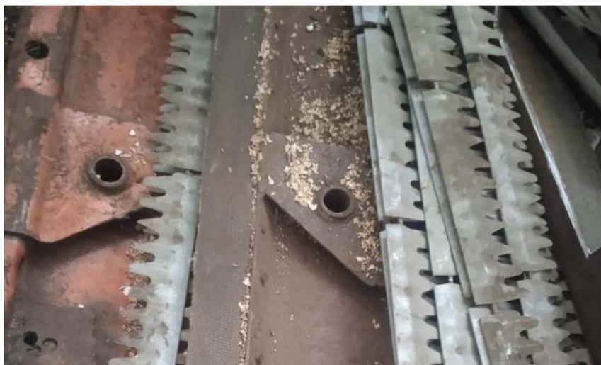
Рисунок 3. Технологические отверстия для регулировки угла наклона удлинителя относительно плоскости верхнего решета комбайна «Дон-1500А» 80-хх годов выпуска
