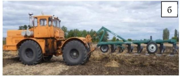
Рисунок 1. Пахотные агрегаты: а) К-701+ПНЛ-8-40; б) К-701+ПБС-8М
