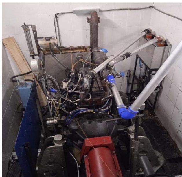
Рисунок 2. Общий вид модернизированного моторного стенда Д-245 под требования метода комплексной оценки эксплуатационных свойств моторных масел
