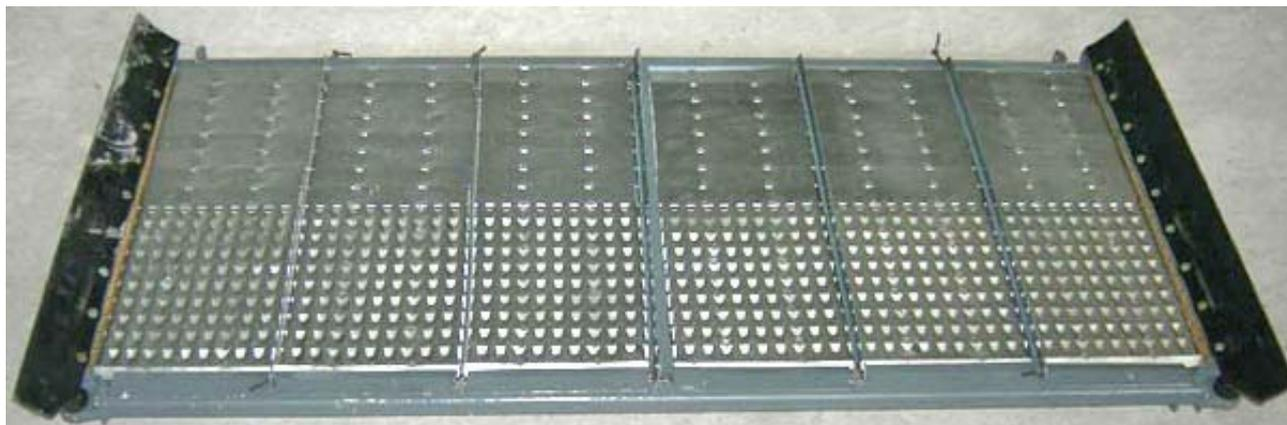
Рисунок 6. Удлинитель верхнего решета комбайна «Дон-1550Б» и модификаций ACROS
