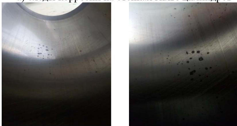
б) образующиеся в процессе эксплуатации раковины на зеркале цилиндра, как следствие работы двигателя со следами первоначальной коррозии
