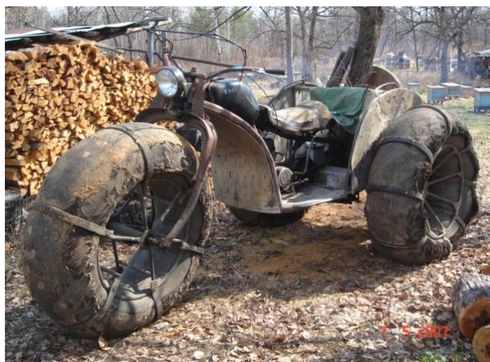
Рис. 1. Трицикл-вездеход с установленными пневматиками низкого давления.
