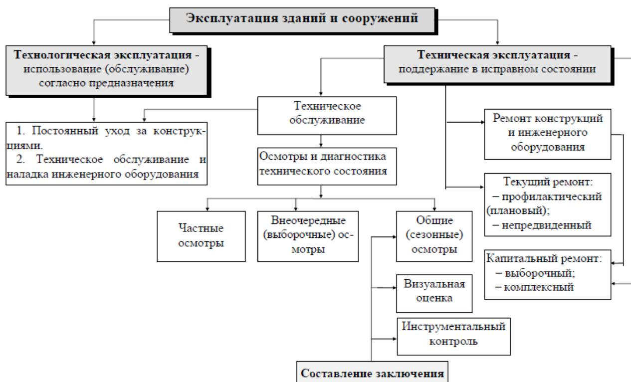
Рисунок 1 - Состав мероприятий по эксплуатации зданий и сооружений[2-4]
