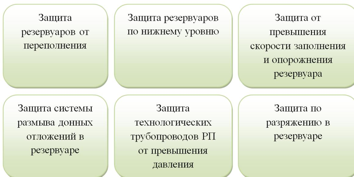
Рисунок 2 - Защита резервуарного парка
