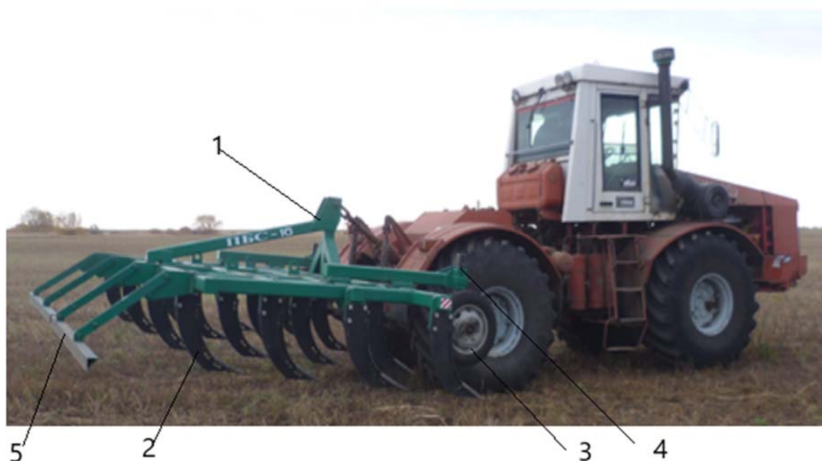
Рисунок 1. Плуг-рыхлитель ПБС-16 в составе с трактором К-744Р: 1 – рама; 2 – рабочий орган; 3 – опорное колесо; 4 – механизм установки глубины; 5 – выравниватель
