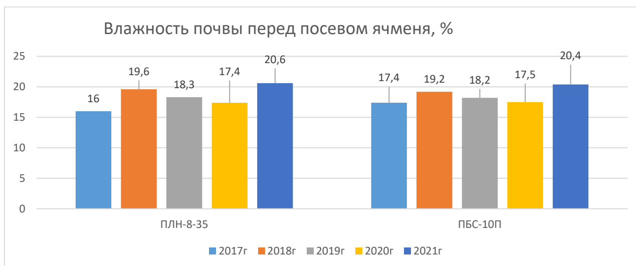
Рисунок 3. Диаграмма влажности почвы в слое 0–50 см после вспашки плугами ПЛН-8-35 и ПБС-10П
