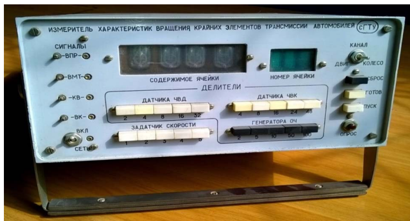
Рисунок 3. Устройства поэлементной диагностики трансмиссии АТС
