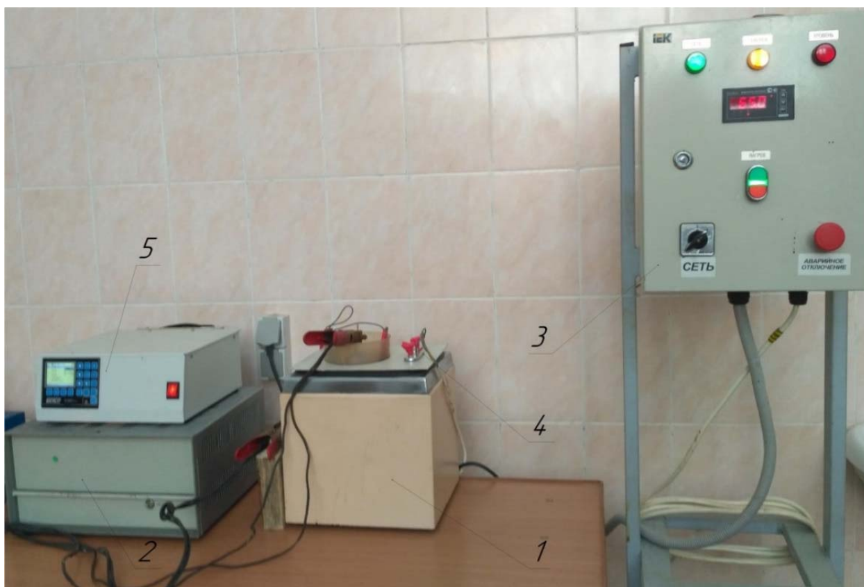
Рисунок 1. Лабораторная ультразвуковая гальваническая установка: 1 – ультразвуковая ванна; 2 – блок питания ультразвуковой ванны; 3 – шкаф управления и поддержания заданной температуры; 4 –нагревательный элемент; 5 – выпрямитель ГИТП 500-30(5)х12Р-220-П2/В2
