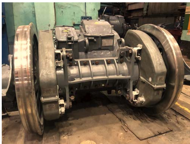
Рисунок 3. КЗП, установленные на КМБ локомотива 2ЭС5К
