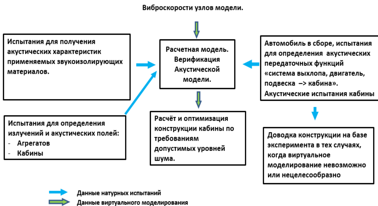
Рисунок 2. Связь и обмен данными эксплуатационных и виртуальных испытаний при исследовании объекта на акустику
