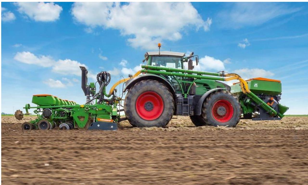
**Рис.2. Сеялка Presea 6000-2AFCC с ротационным культиватором KG 6002-2 и FTender**
