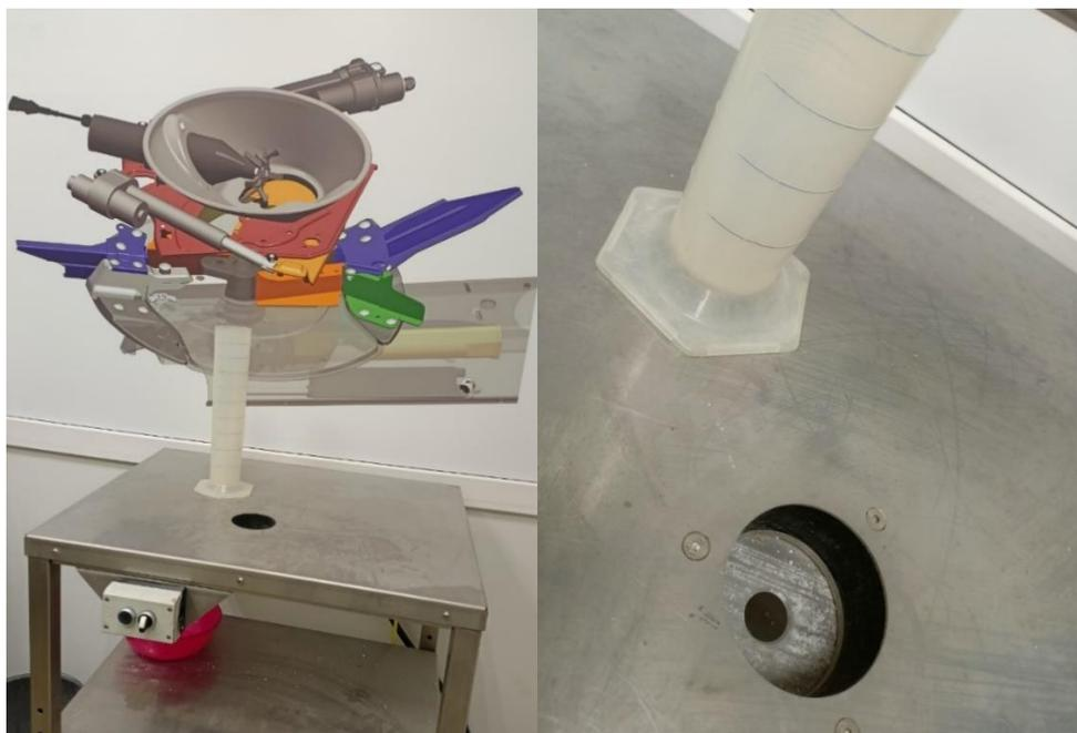
**Рис.1. Стенд для определения скорости прохождения удобрений из бункера на рабочий орган-метатель удобрений**
