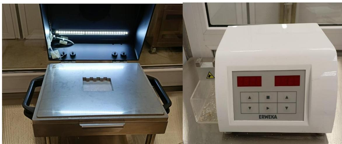
**Рис.2. Оборудование для определения размерности и удельного веса гранул**
