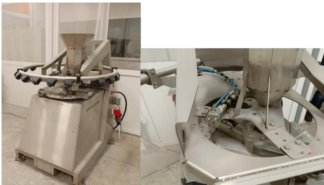
**Рис.3.Оборудование-стенд для оценки динамических свойств удобрений по траектории полета для оптимальной установки места выгрузки удобрений**
