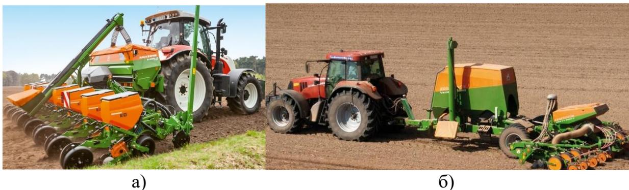
**Рис.1. Сеялки АО «Евротехника» - точного высева: а)-ED, б)-EDX**
