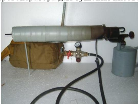
Рисунок 11 - Автономный парогенератор
