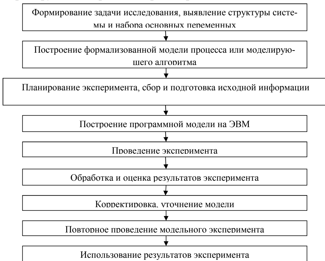
Рисунок 2 - Последовательность имитационного моделирования
