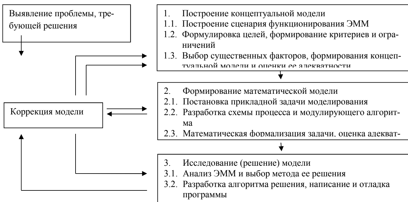
Рисунок 1 - Этапы построения имитационной модели. При использовании методов моделирования при градостроительном прогнозе необходимо следовать правилу: если возможно, то
