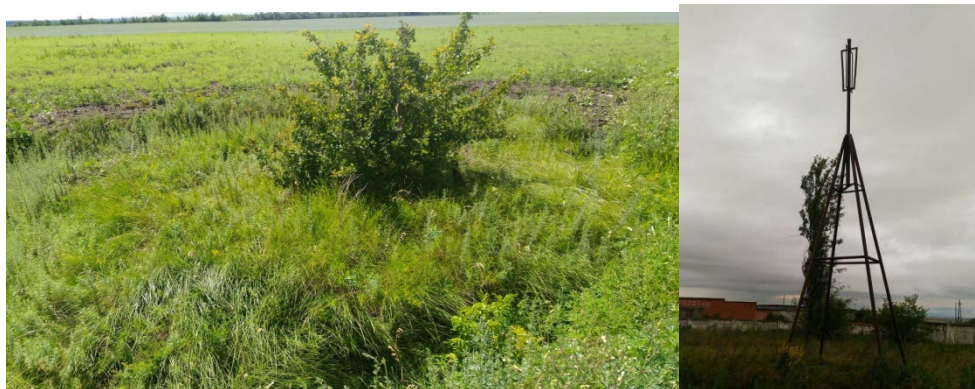
Пункт Банифатьевка (слева): утрачен наружный знак, сохранились центр и марка, окопан; пункт Петровский тракт зап. (справа): сохранился
