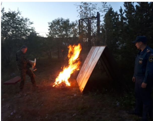
Испытание заградительного устройства в ночное время с имитацией высоты распространения низового пожара более 1,5 м
