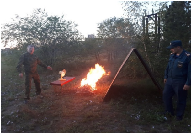
Испытание заградительного устройства с имитацией скорости распространения низового пожара силой более 3 м/мин.
