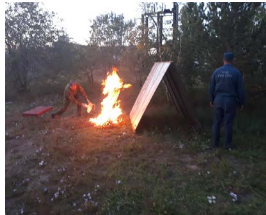
Испытание заградительного устройства с имитацией высоты распространения низового пожара более 1,5 м
