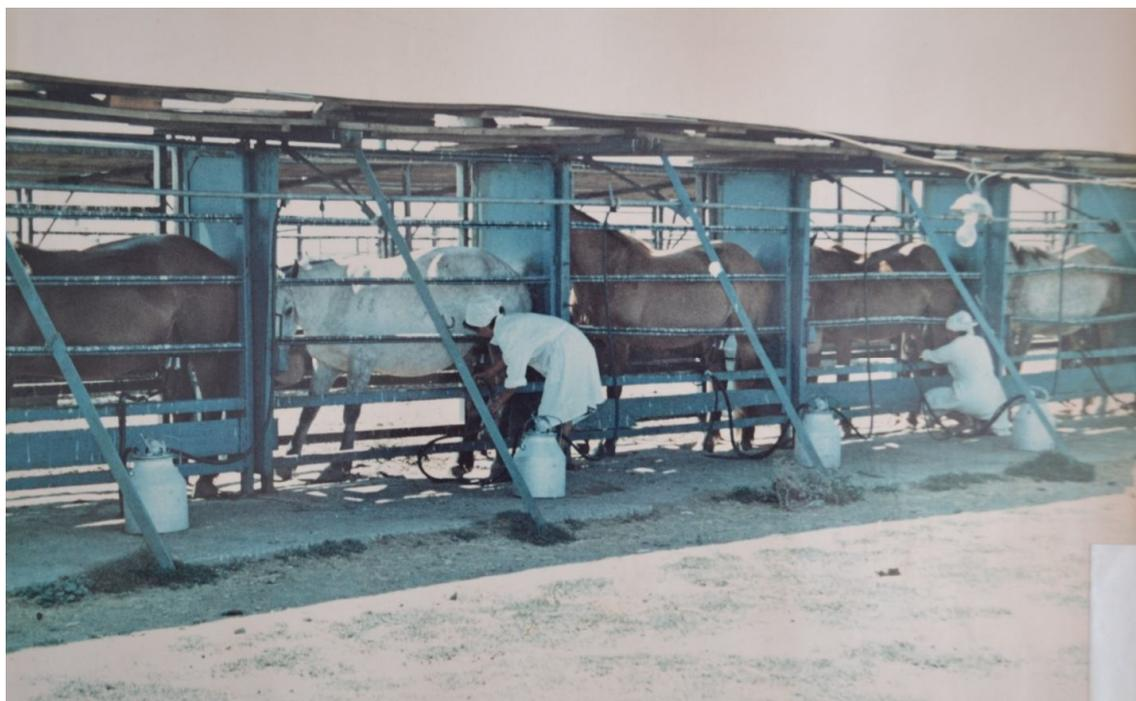
Рис. 2 Доильная установка «Цепочка» на 120 дойных кобыл
