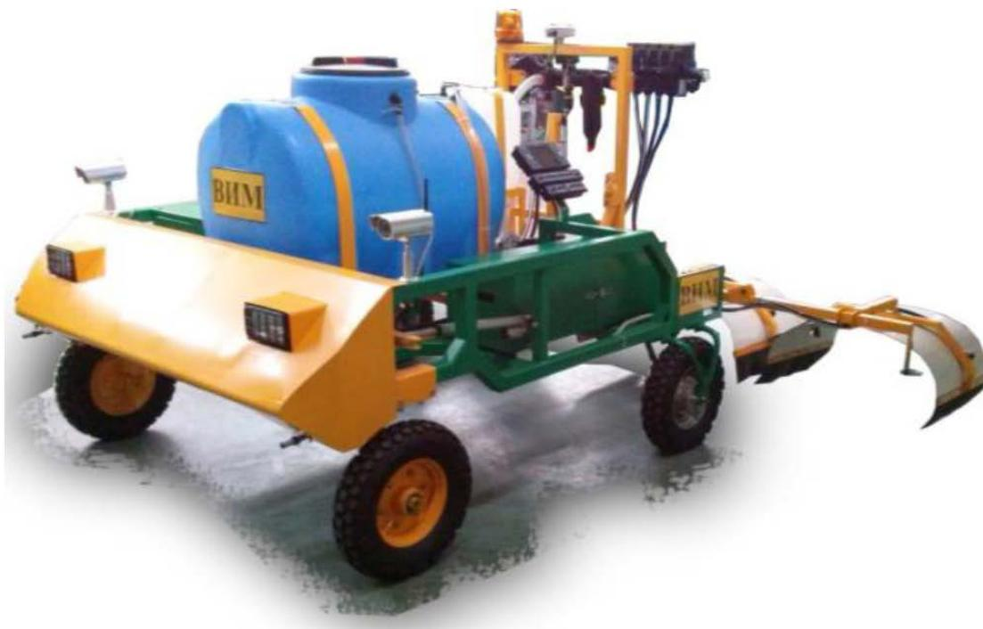
**Рис. 3. Роботизированный опрыскиватель для низкорастущих культур**
