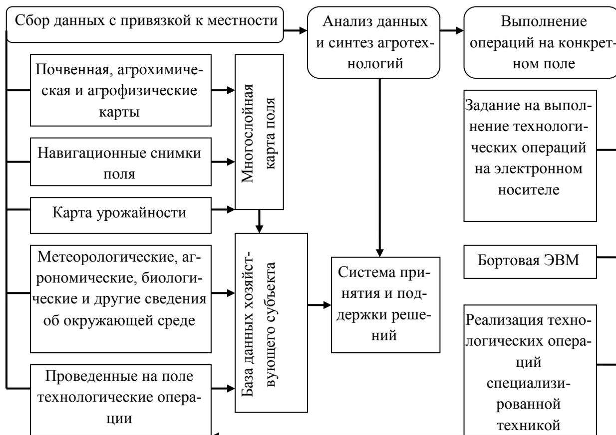
**Рис. 1. Структура и основные функции программно-аппаратного комплекса по точному земледелию [сост. авт. по 2, 3, 5]**
