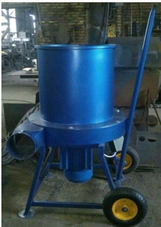
Рисунок 3. Передвижная дробилка ИС-850 для измельчения камыша
