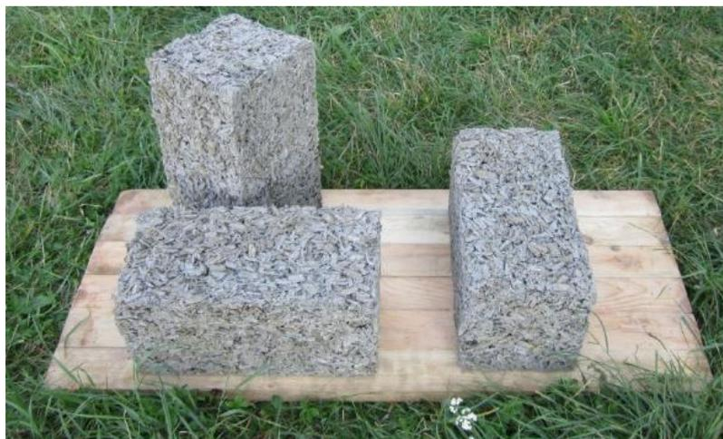
Рисунок 7. Готовые блоки после формовки
