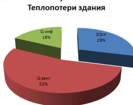
Рисунок 1. Анализ тепловых потерь здания
