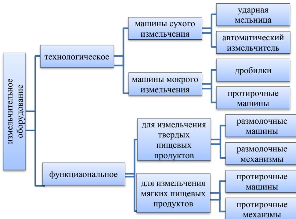
Рисунок 1. Классификация измельчающих машин по способам измельчения
