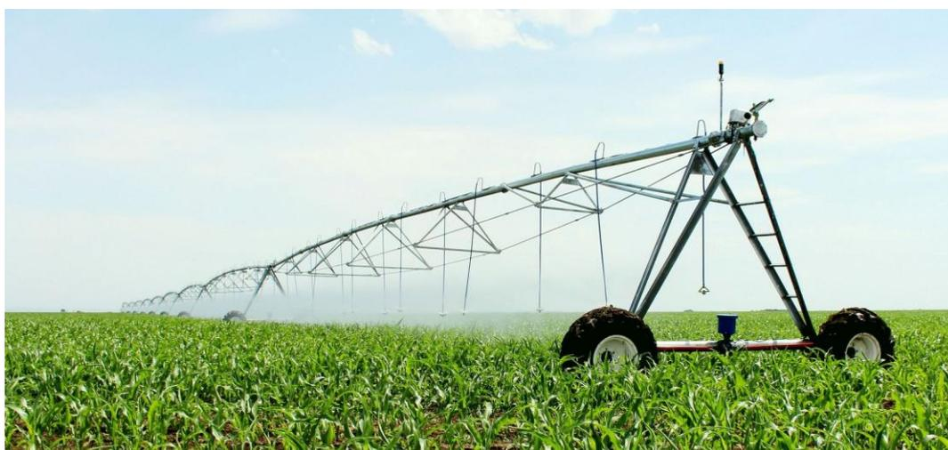
Рисунок 1. Дождевальная машина «Кубань –ЛК1М» (КАСКАД)
