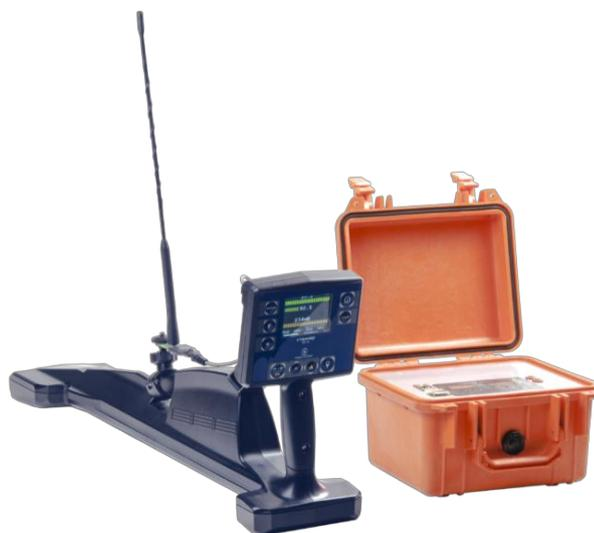
Рисунок 6. Трассопоисковый комплекс «Сталкер 75-14»
