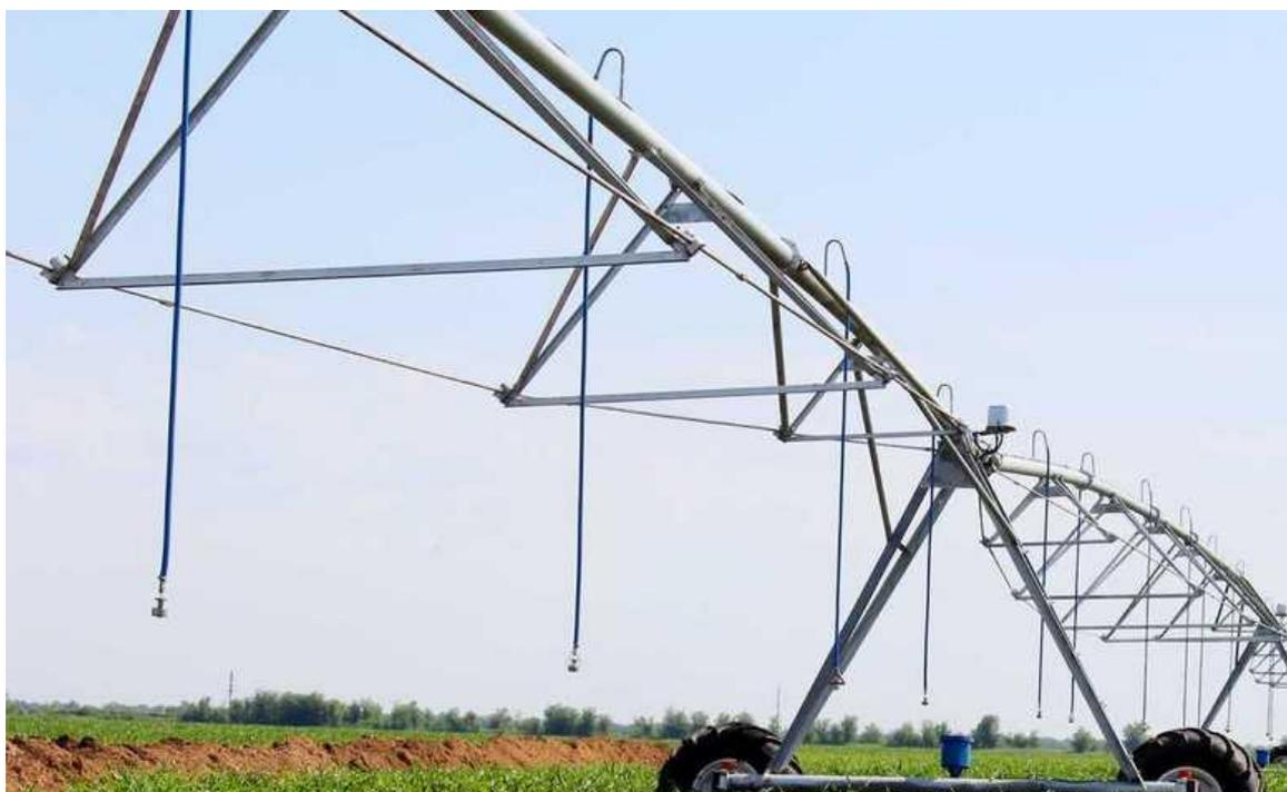
Рисунок 5. Дождеобразующие устройства
