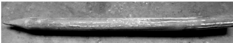
Рисунок 2. Модель пневмопробойника ИП4605 в масштабе 1:2
