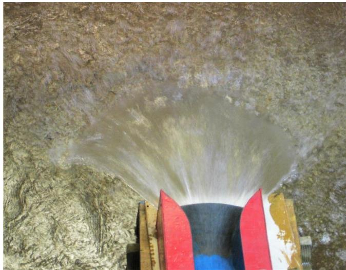
Рисунок 6. Работа рассеивающего трамплина при пропуске расчетного расхода
