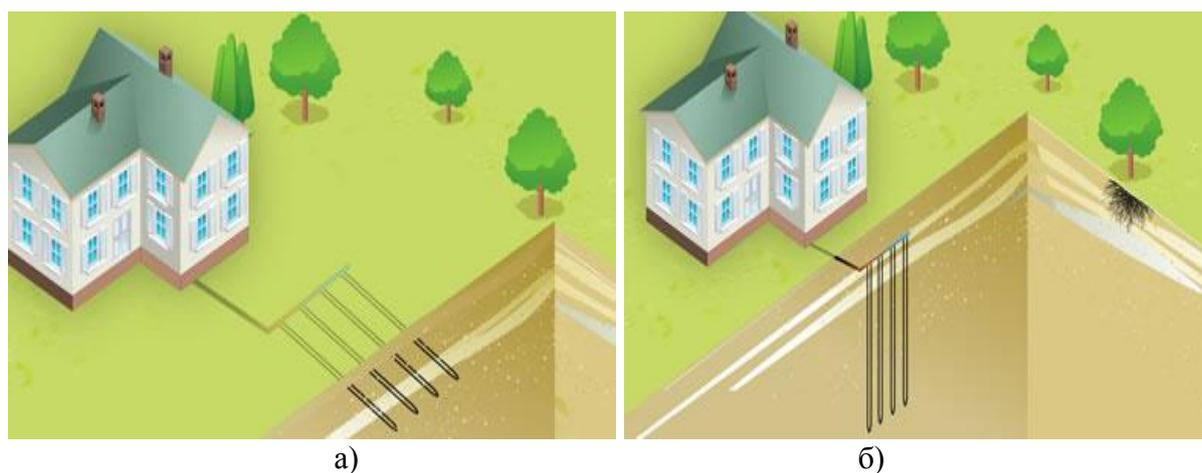
Рисунок 1. Виды укладки труб системы геотермального отопления:
