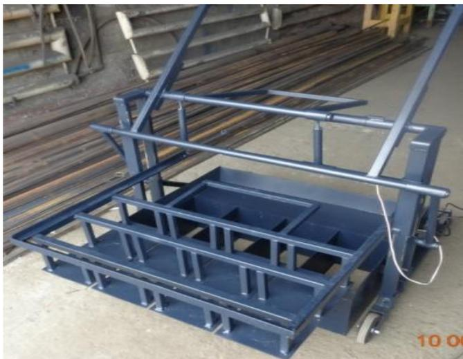
Рисунок 5. Вибростанок по производству арболита.
