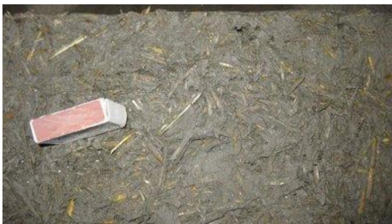
Рисунок 6. Полученная структура после виброукладки смеси
