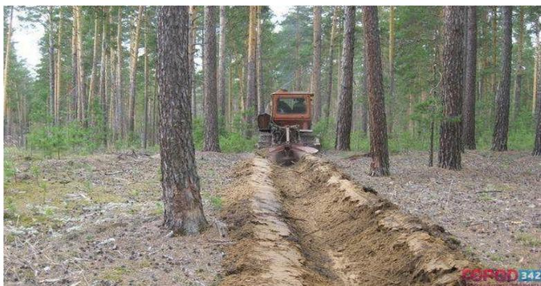
Рисунок 1. Заградительная минерализованная полоса
