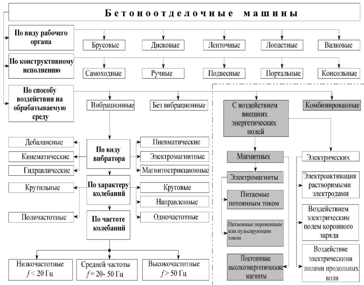
Рисунок 1. Классификация бетоноотделочных машин
