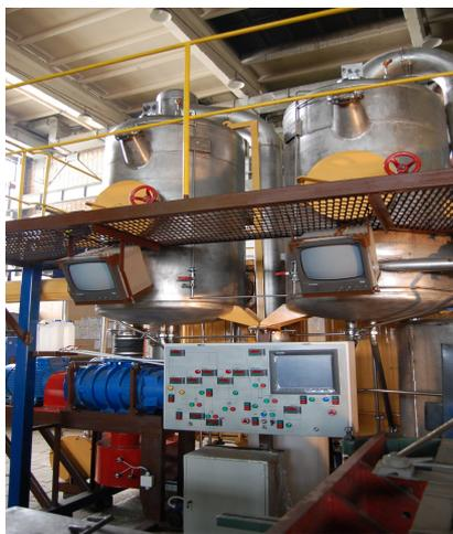
**Рис. 1. Общий вид УБиМ-ППТК - «блок вакуум-выпарной двухконтурный»**
