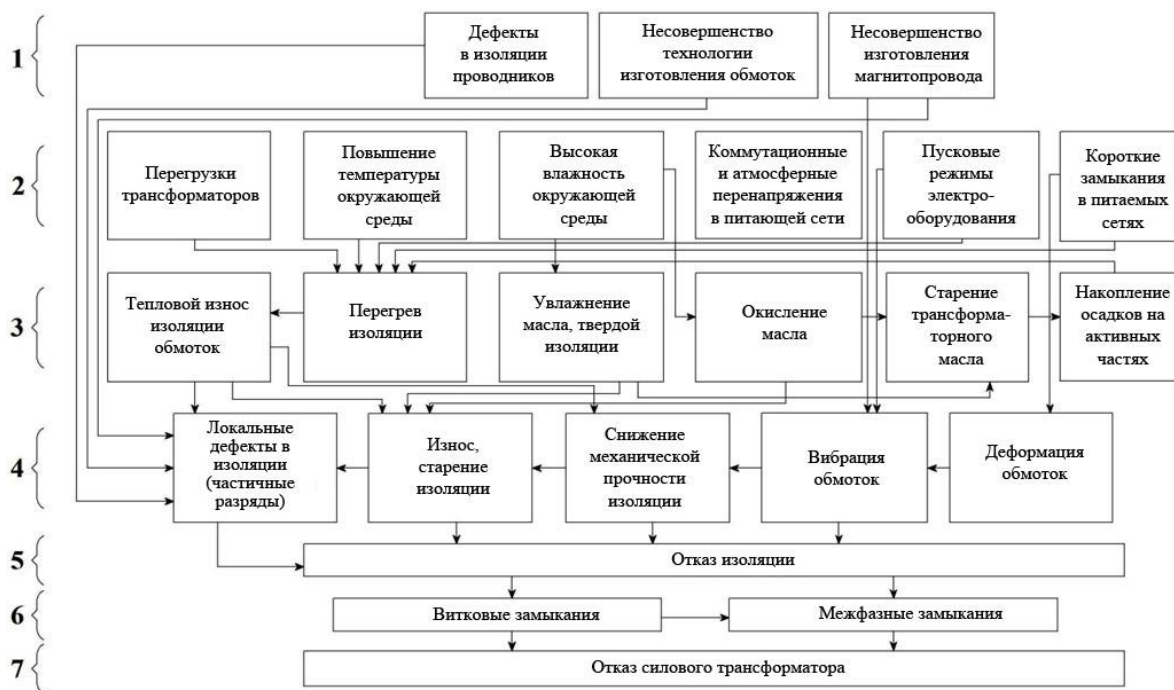
Рисунок 1.1 – Схема развития повреждений изоляции трансформаторов:
