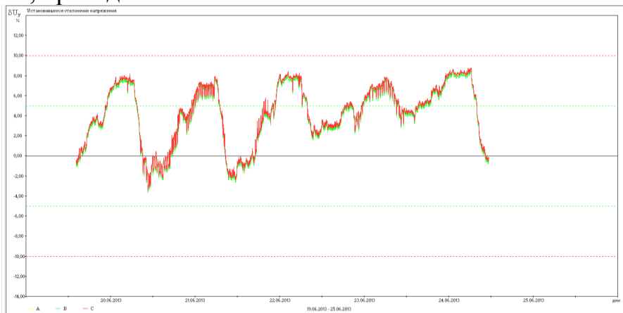
Рисунок 1- Результаты измерения установившегося отклонения напряжения фаз
