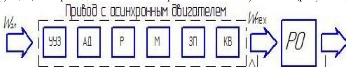
Рисунок 1. Структурная схема привода с АД (АД–асинхронный двигатель, УУЗ–устройство управления и защиты, Р – редуктор; М – маховик; ЗП – зубчатая передача; КВ – коленчатый вал; РО – рабочий орган).
