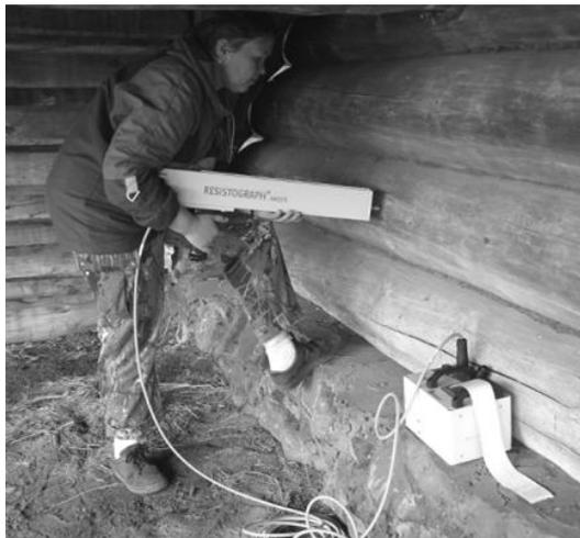
Рисунок 5. Обследование состояния древесины стен здания
