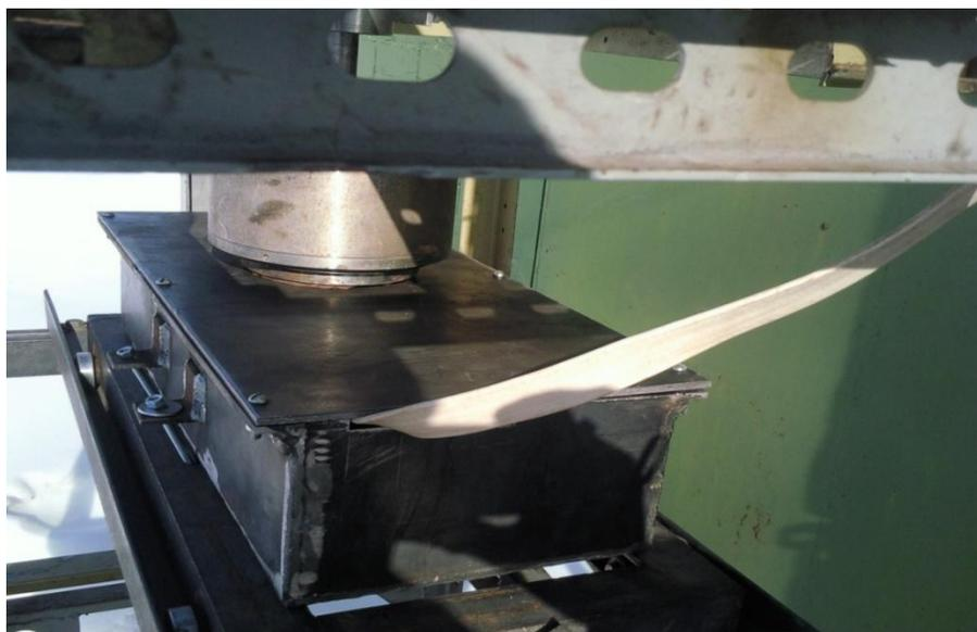
Рисунок 3. Имитатор поверхности ковша с подключенным нагревательным элементом ЭНГЛ-1, перед срывом
