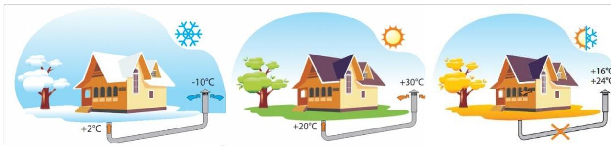
Рисунок 1. Схема работы геотермальной вентиляционной системы зимой, летом и в межсезонный период
