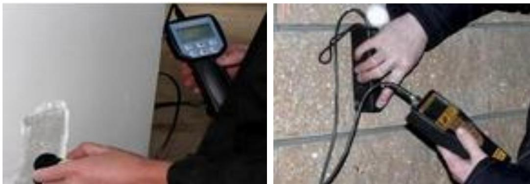
Рисунок 1. Применение ультразвукового метода проверки стен зданий
