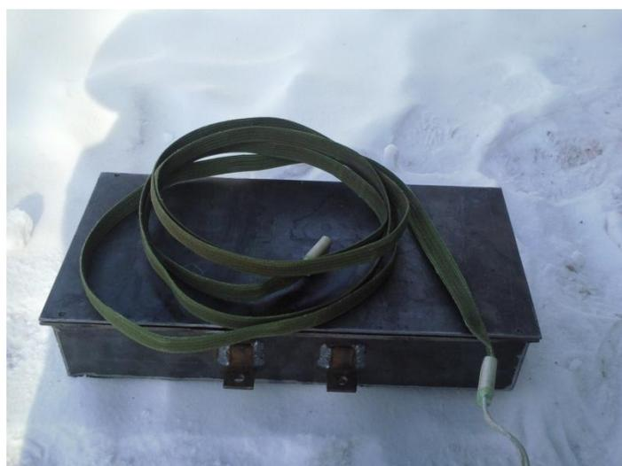
Рисунок 2. Имитатор поверхности ковша с нагревательным элементом ЭНГЛУ-400
