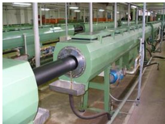
Рисунок 1. Технологическое оборудование для изготовления полиэтиленовых труб низкого давления
