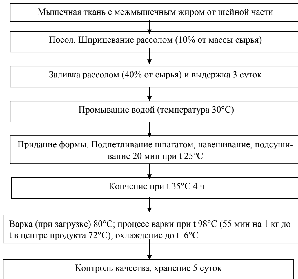
Рис. 2. Технологическая схема производства шейки копчено-вареной
