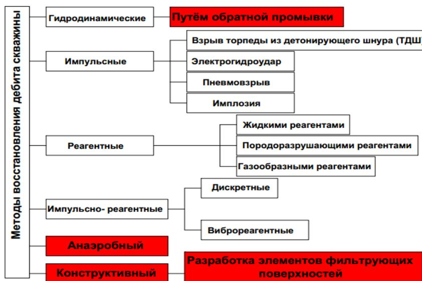
Рис. Схема методов восстановления дебита скважин.
