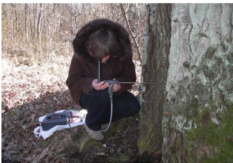
Рис. 3. Исследование состояния древесины бороскопом
