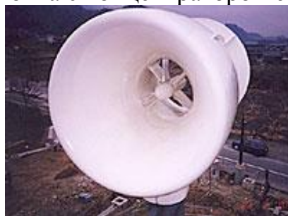
Рисунок 1. Ветроэнергетическая установка с концентратором энергии.
