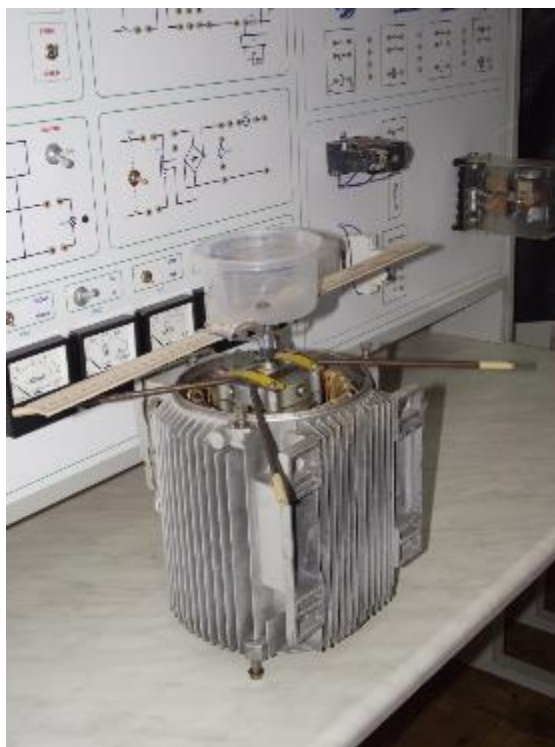
Рисунок 2. Модернизированная установка капельной пропитки УКП-2.
