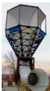
Рисунок 2. Ветроэнергетическая установка с дефлекторным устройством
