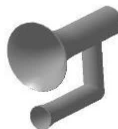
Рисунок 5. Ветроэнергетическая установка с турбиной Вентури
