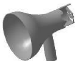
Рисунок 1. Ветроэнергетическая установка с концентратором энергии.
