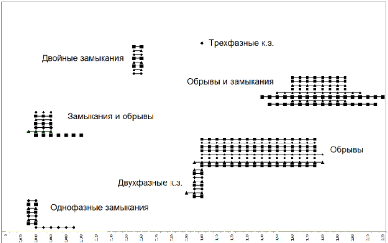
Рисунок 1. Интервалы отношений напряжений поврежденных фаз к напряжениям неповрежденных фаз для всех видов аварийных режимов и рассмотренных параметров фидеров 35 кВ.
