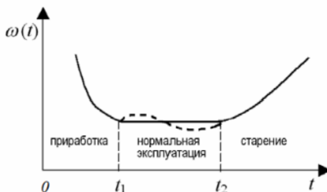
Рисунок 1. Зависимость интенсивности отказов от времени работы.
