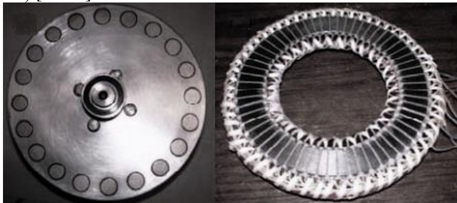
Рисунок 5. Пример ротора и статора СГПМ
