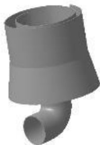
Рисунок 4. Ветроэнергетическая установка с вихревым устройством
