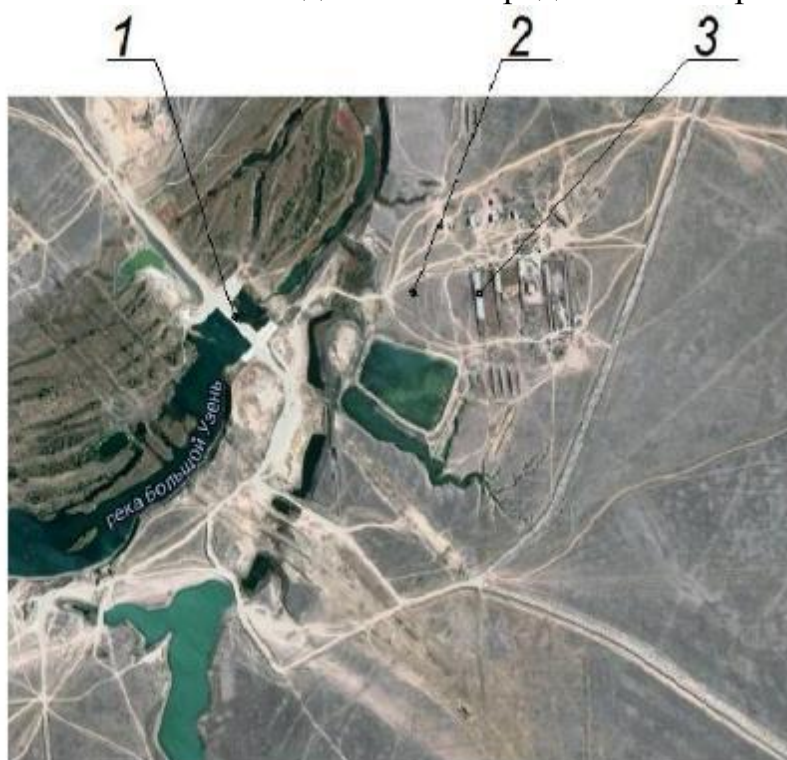
Рисунок 1. Снимок фермерского хозяйства «Комплекс» и переливной плотины: 1.мини ГЭС; 2.ветрогенератор; 3.солнечные панели.
