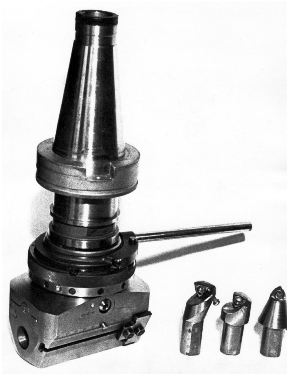
Рисунок 5.2 – Общий вид универсальной расточной головки с набором резцов
