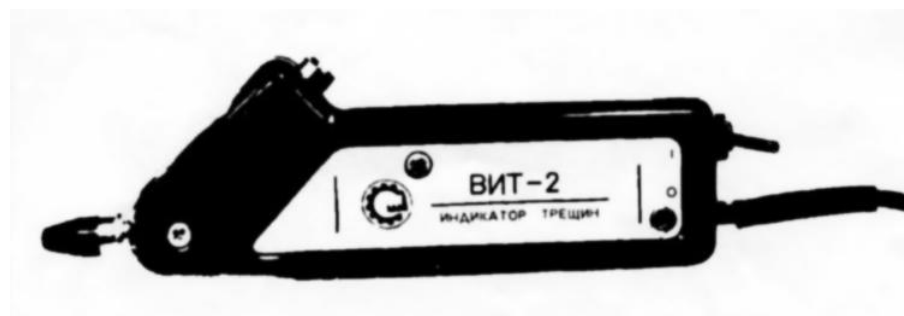
Рисунок 2.21 - Дефектоскоп для определения термоусталостных трещин ВИТ-2
