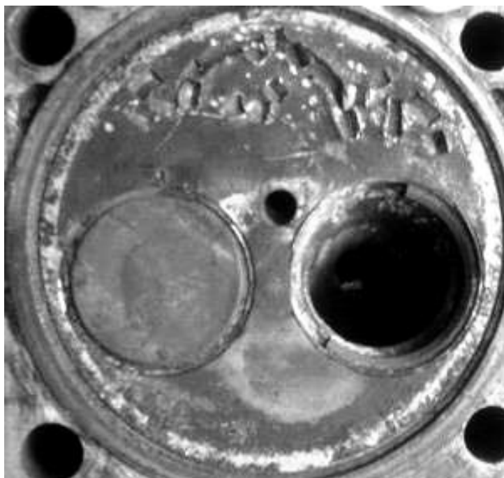
Рисунок 1.2 - Трещина в межклапанной перемычке головки двигателя ЯМЗ-238НБ
