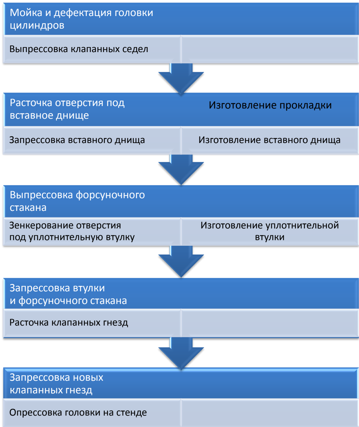
Рисунок 5.1 – Схема технологического процесса восстановления головок цилиндров дизелей ЯМЗ-238НБ, ЯМЗ-240Б, А-41 и А01М с трещинами установкой вставных огневых днищ
