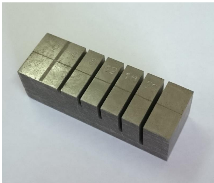
Рисунок 2.4 – Образец из материала аналогичного материалу ГЦ с прорезями, имитирующими трещину глубиной 0-20 \cdot 10^{-3} м.
