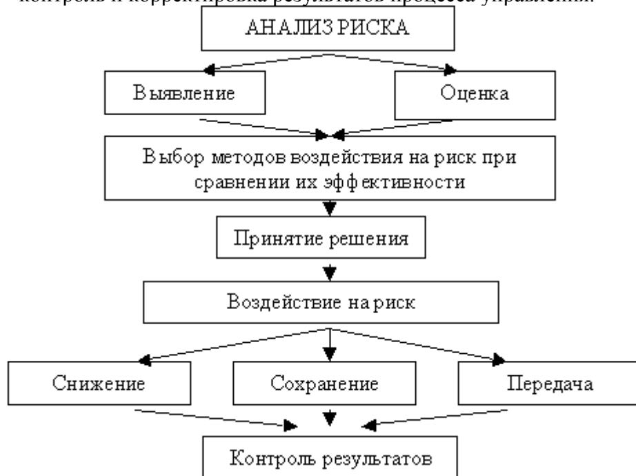
Рисунок 2 - Схема процесса управления риском
