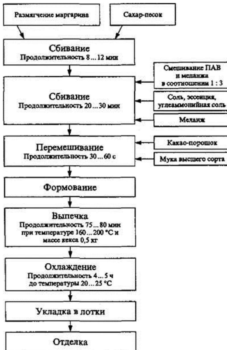
**Рисунок 1.** Технологическая схема производства кекса «Особый» с поверхностно-активными веществами (пастой для сбивания)
