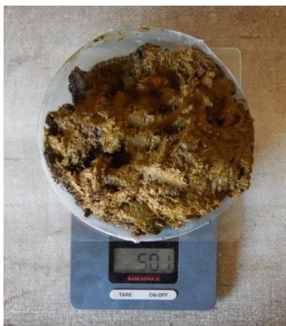
Рисунок 3.1 – Определение плотности экскрементов телят
