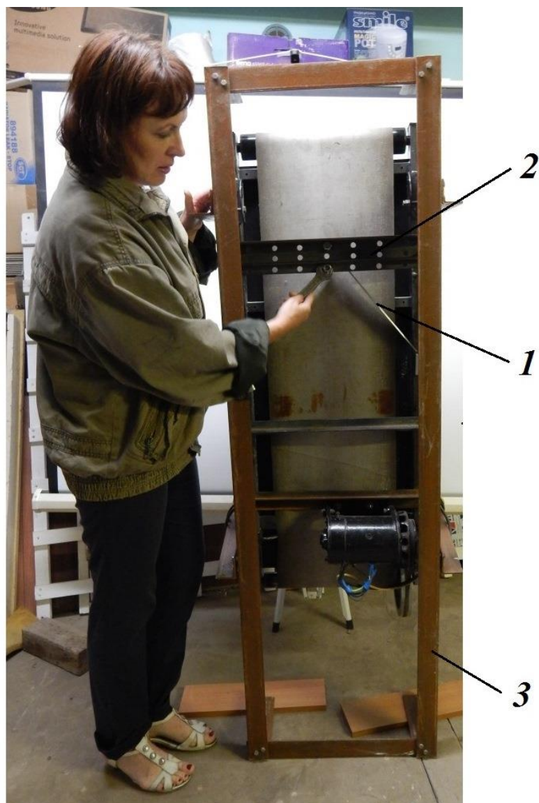
Рисунок 5.1 – Монтаж скребка очищающего к корпусу в подсобном помещении телятника: 1 – скребок очищающий; 2 – корпус скребка очищающего; 3 – рама клетки
