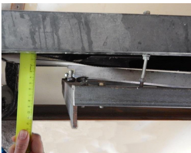
Рисунок 5.3 – Положение провисания ленты относительно плоскости
