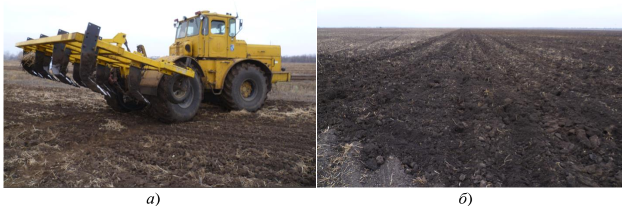
Рисунок 17 – Пахотный агрегат (а), состоящий из трактора К-701+ПБФР-5, и поле (б), обработанное пахотным агрегатом
