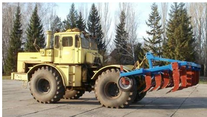
Рисунок 13 - Экспериментальный фронтальный плуг-рыхлитель (1) в агрегате с трактором К-701 (2), в транспортном положении
