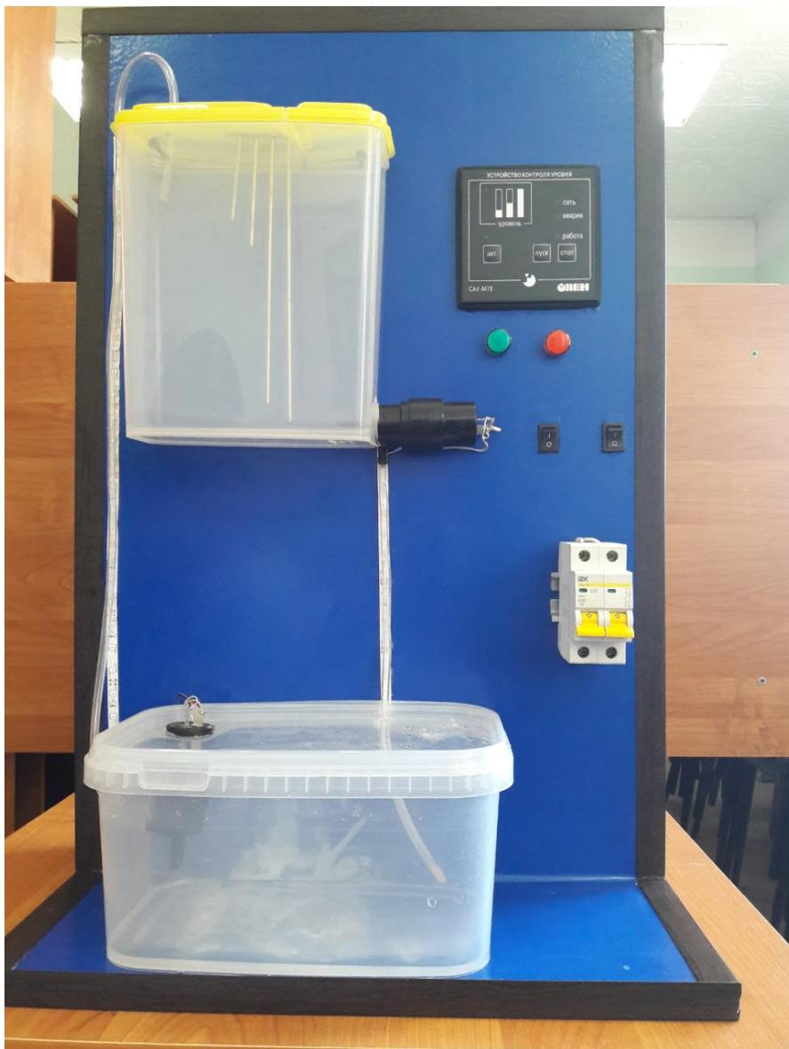
Учебный макет предназначен для изучения системы автоматического регулирования уровня воды в емкости с использованием сигнализатора уровня жидкости САУ-М7Е.
