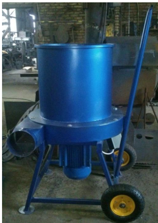
Рисунок 3. Передвижная дробилка ИС-850 для измельчения камыша
