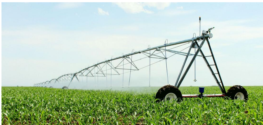
Рисунок 1. Дождевальная машина «Кубань –ЛК1М» (КАСКАД)
