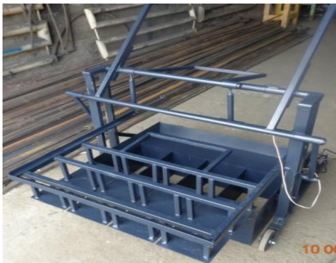
Рисунок 5. Вибростанок по производству арболита.
