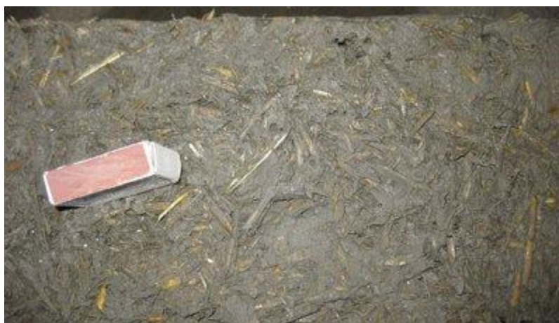
Рисунок 6. Полученная структура после виброукладки смеси
