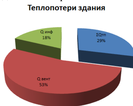
Рисунок 1. Анализ тепловых потерь здания
