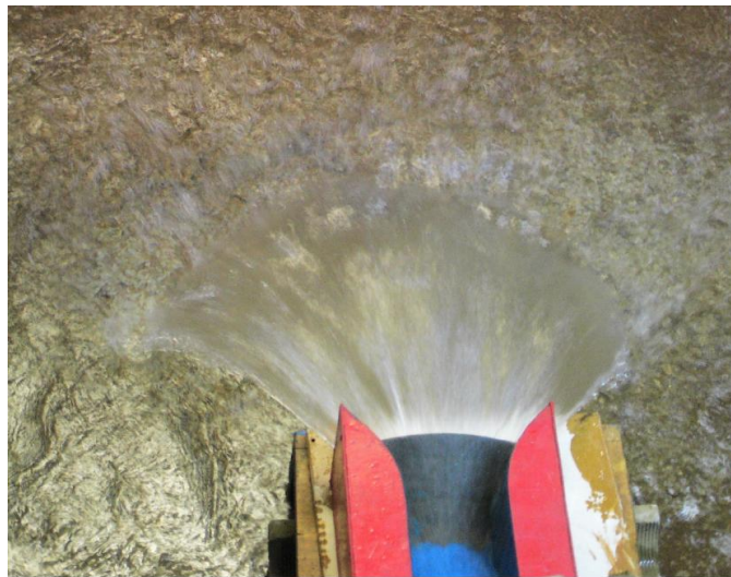
Рисунок 6. Работа рассеивающего трамплина при пропуске расчетного расхода
