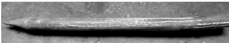
Рисунок 2. Модель пневмопробойника ИП4605 в масштабе 1:2
