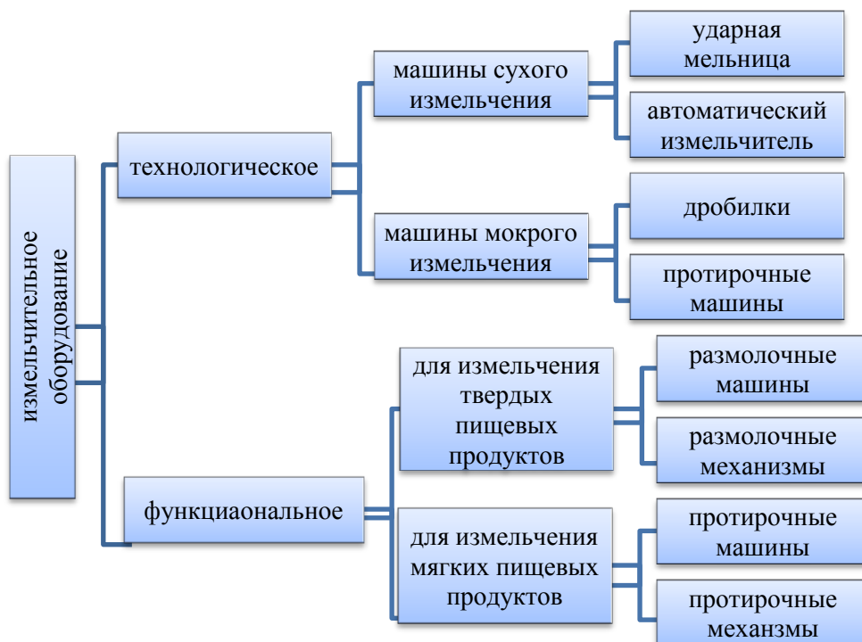
Рисунок 1. Классификация измельчающих машин по способам измельчения
