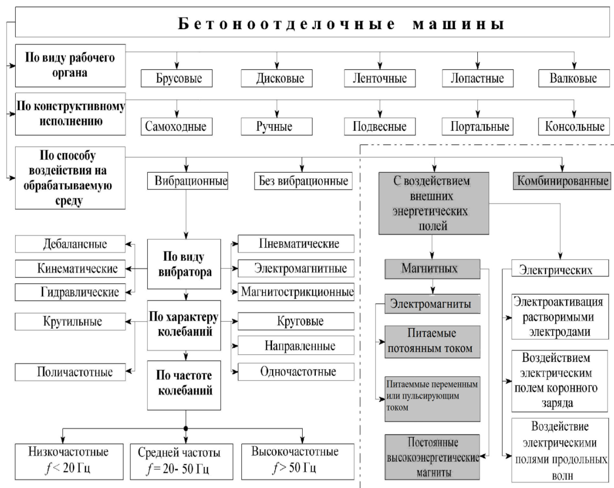
Рисунок 1. Классификация бетоноотделочных машин
