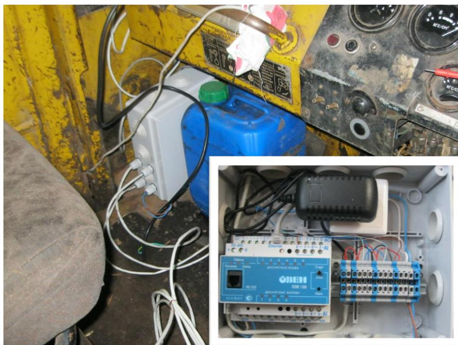
Рисунок 5.15 – Установка контроллера ИС в кабине трактора
