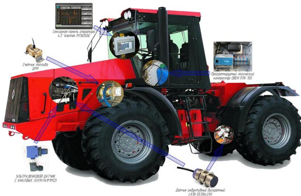
Рисунок 4.10 – Расположение элементов информационной системы на тракторе типа «Кировец»
