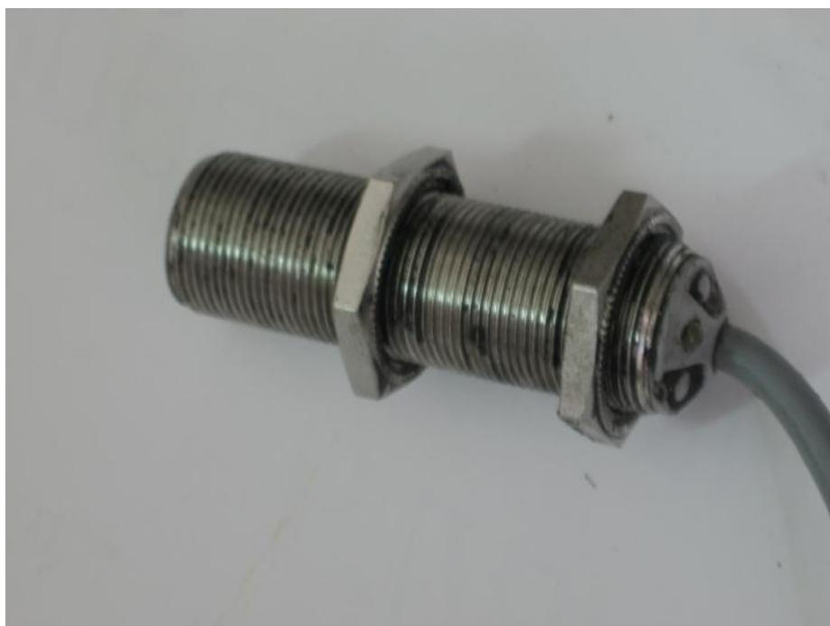
Рисунок 4.8 – Индуктивные датчики серии LA18-55.5N4.U1.K
