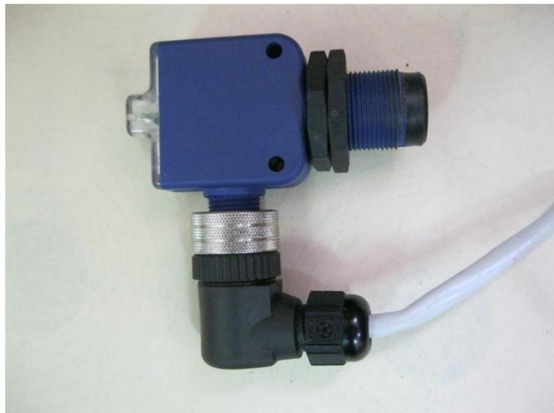
Рисунок 4.9 – Бесконтактный ультразвуковой акустический датчик
