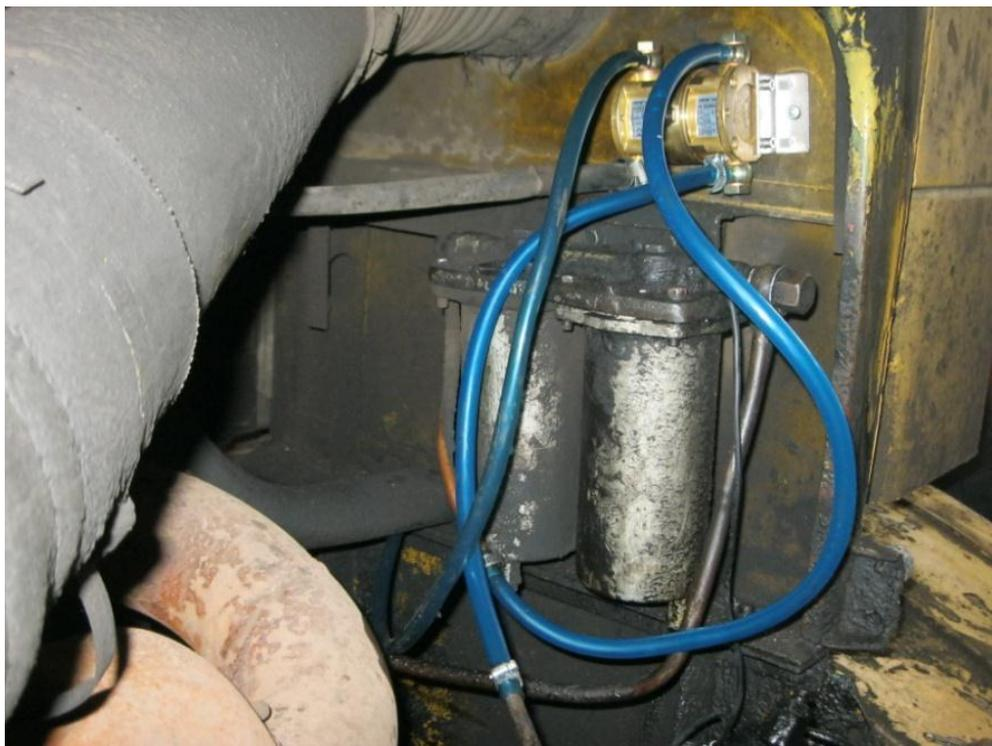
Рисунок 5.13 – Установка дифференциального расходомера на тракторе
