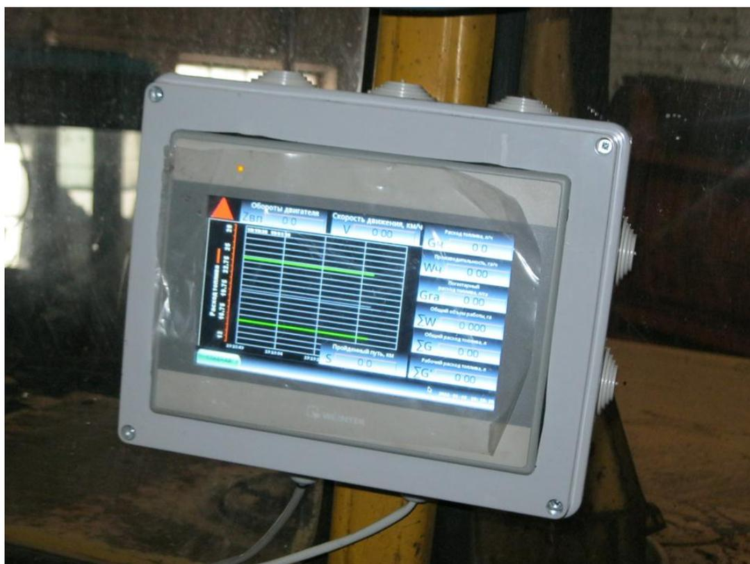
Рисунок 5.14 – Установка панели ИС в кабине трактора
