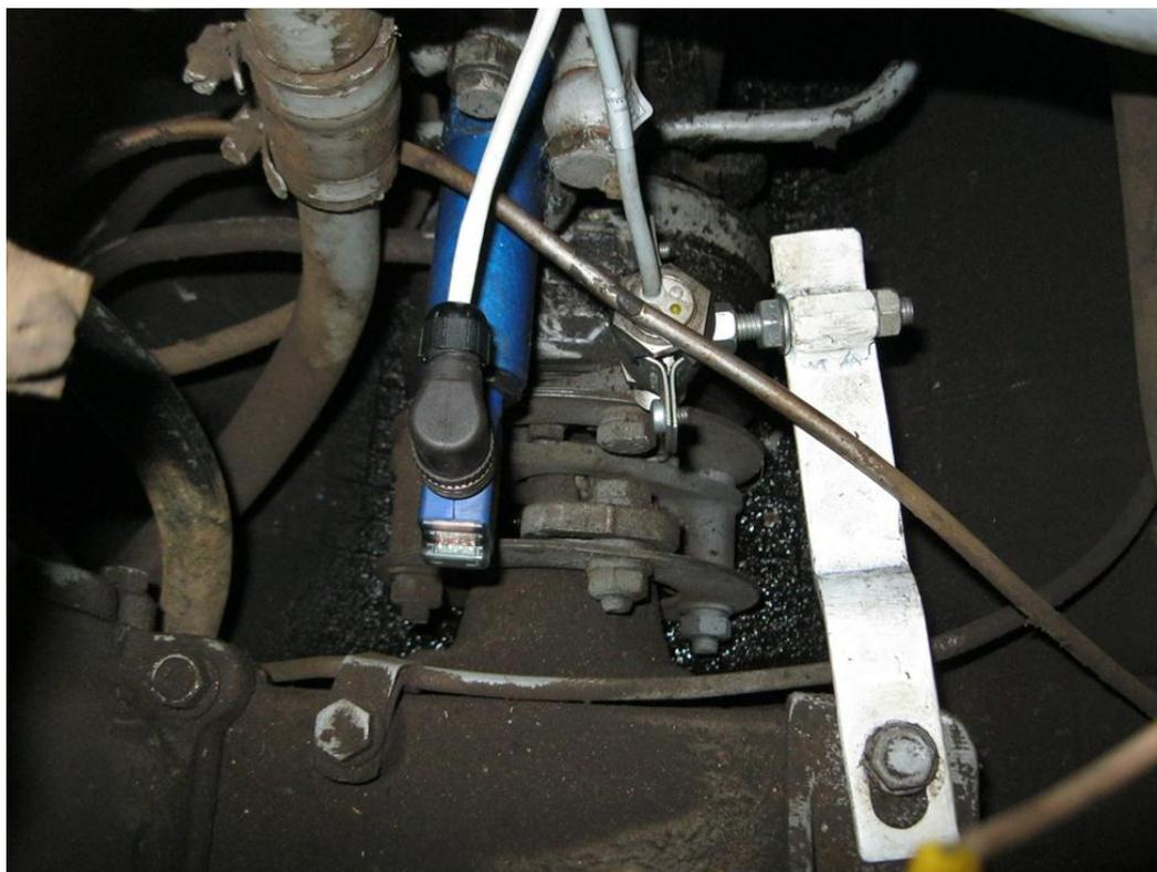
Рисунок 5.7 – Установка датчика положения рейки на ТНВД
