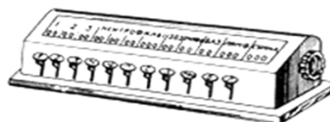
Рис. 12. Одиннадцатиклавишный счетчик для подсчета лейкоформулы
