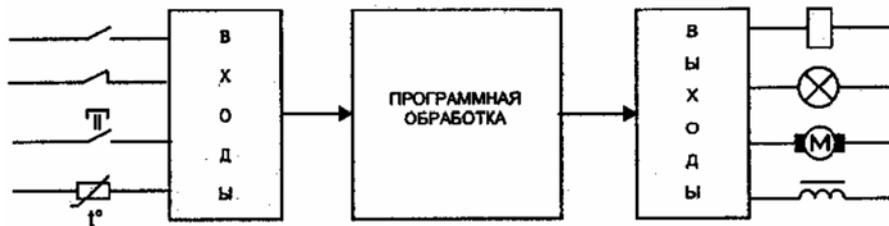
Рис.1.1 – Принцип работы ПЛК.
