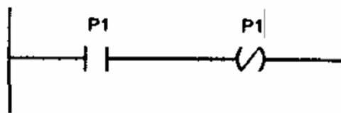
Рис.3.5. Генератор единичных импульсов
