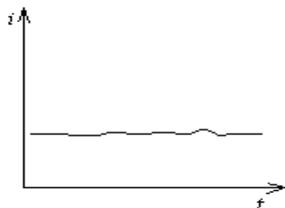
Рис. 2.6. Гидрограф дождя с равномерной интенсивностью
