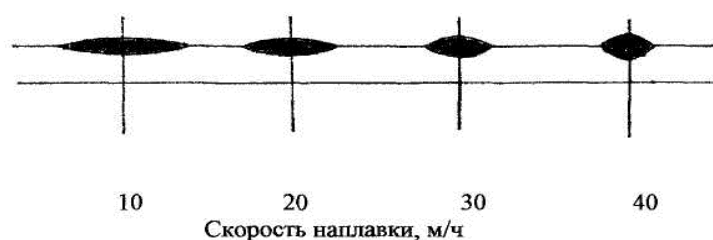
Рис. 3.2. Влияние скорости наплавки на размеры и форму валика металла
