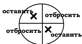
Рисунок 2. Схема квартования пробы
