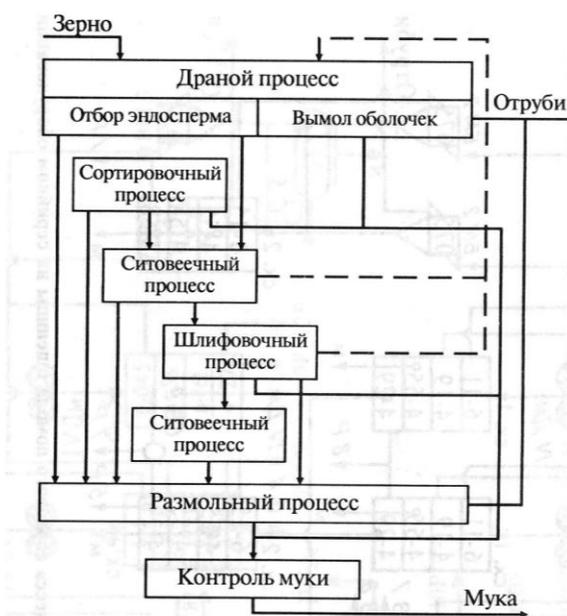
Рисунок 17 – Структурная схема сложного сортового помола пшеницы
